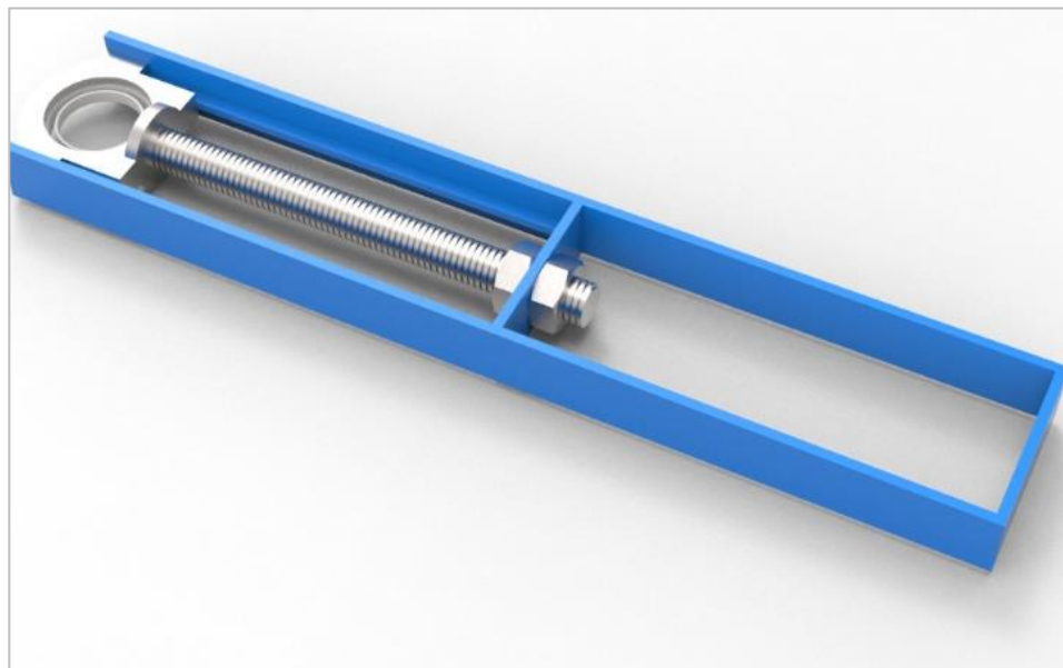
Figura 3.1 Tornillo tensor con tuercas seleccionadas. [Elaboración propia]
