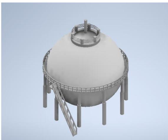
**Figura 2.3 Tanque de almacenamiento esférico (Elaboración propia).**
