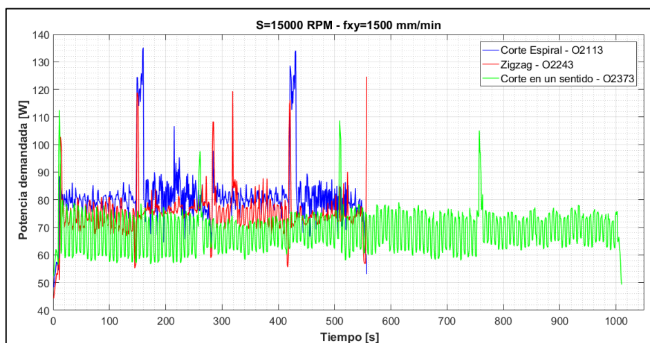
Figura E.3: Potencia vs tiempo entre trayectorias 15000RPM - 1500mm/min
