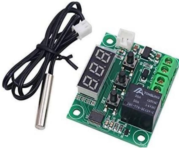
Figura 3.3 Sensor de temperatura W1209.
