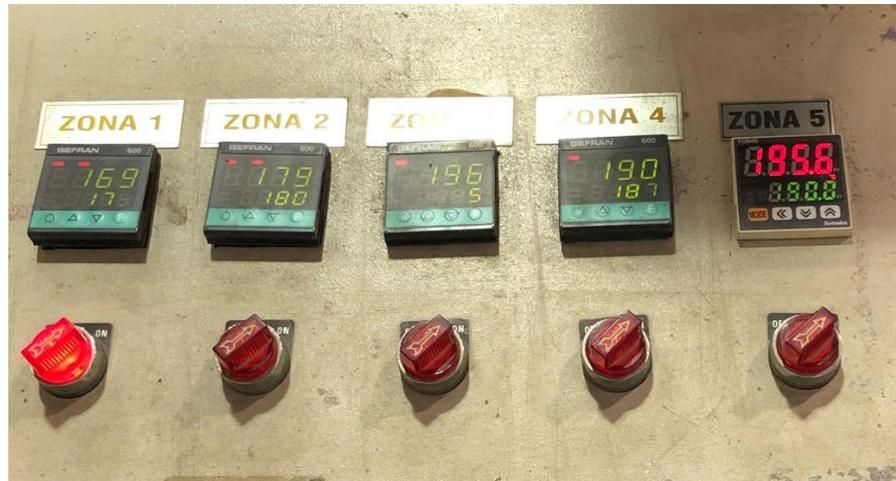
Figura 2.10 Sensores de temperatura de la extrusora
