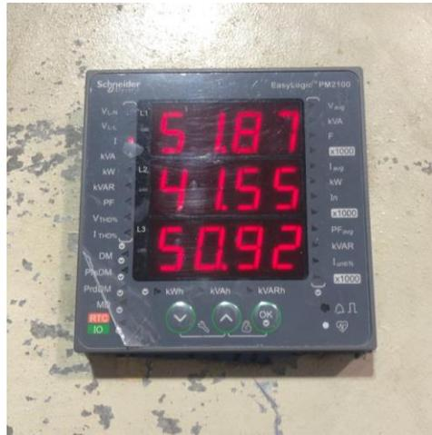
**Figura 2.12** Equipo medidor de consumo energético
