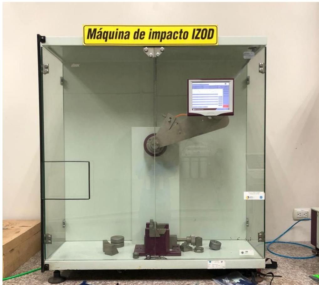
Figura 2.19 Equipo de ensayo de impacto IZOD
