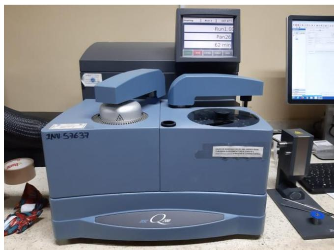
Figura 2.16 Equipo de ensayos DSC
