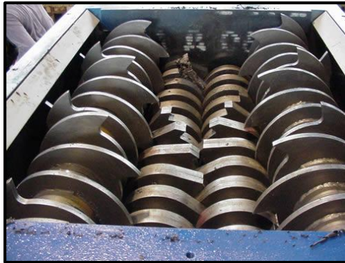
Figura 1.4 Trituradora de discos [Trituradora de latas – Transportes de paneles de madera, 2018]
