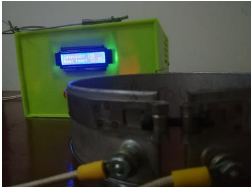
Figura 3.12 Sistema de control conectado a la resistencia [Elaboración propia]
