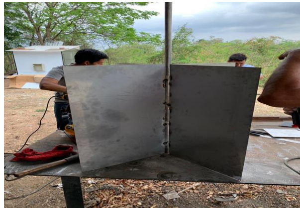
Figura 3. 8 Acople de las palas con el eje. [Elaboración propia]
