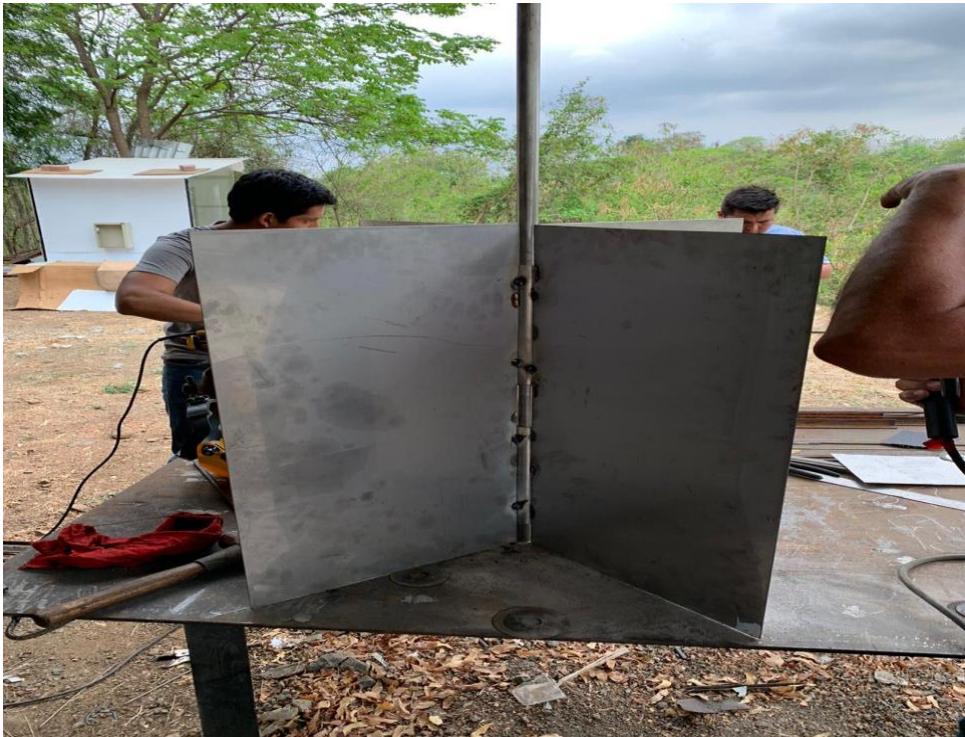
APENDICE A. 7 Ubicación del eje en las aspas. [Elaboración propia]
