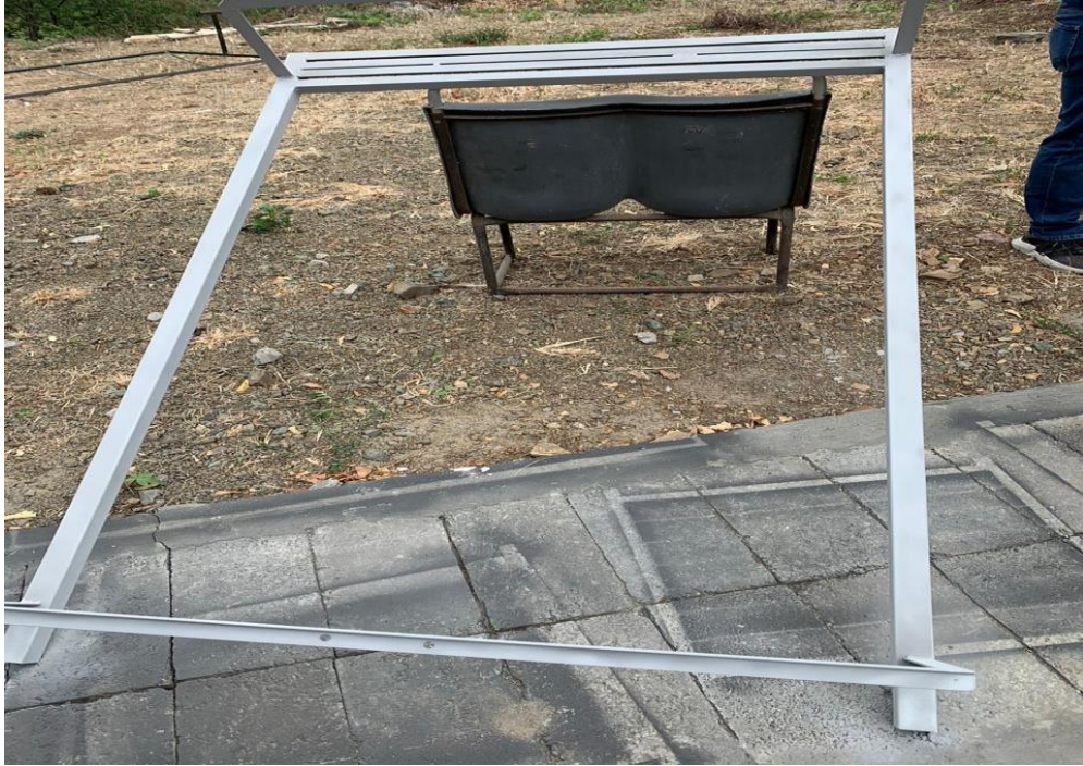
APENDICE A. 6 Aplicación de pintura anticorrosiva a la base. [Elaboración propia]
