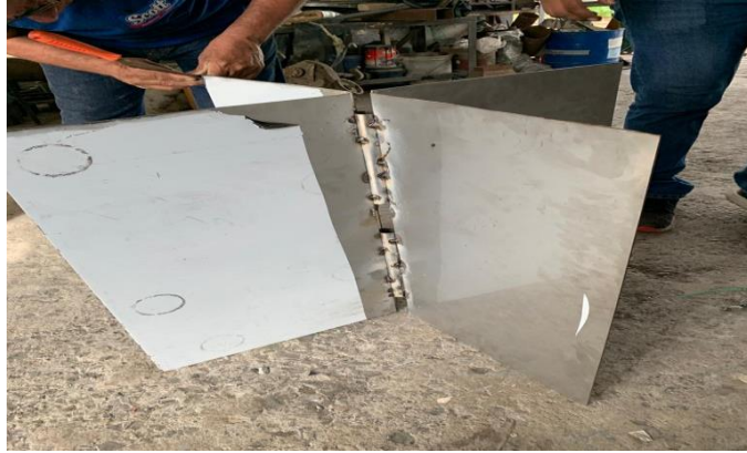
Figura 3. 7 Palas soldadas. [Elaboración propia]
