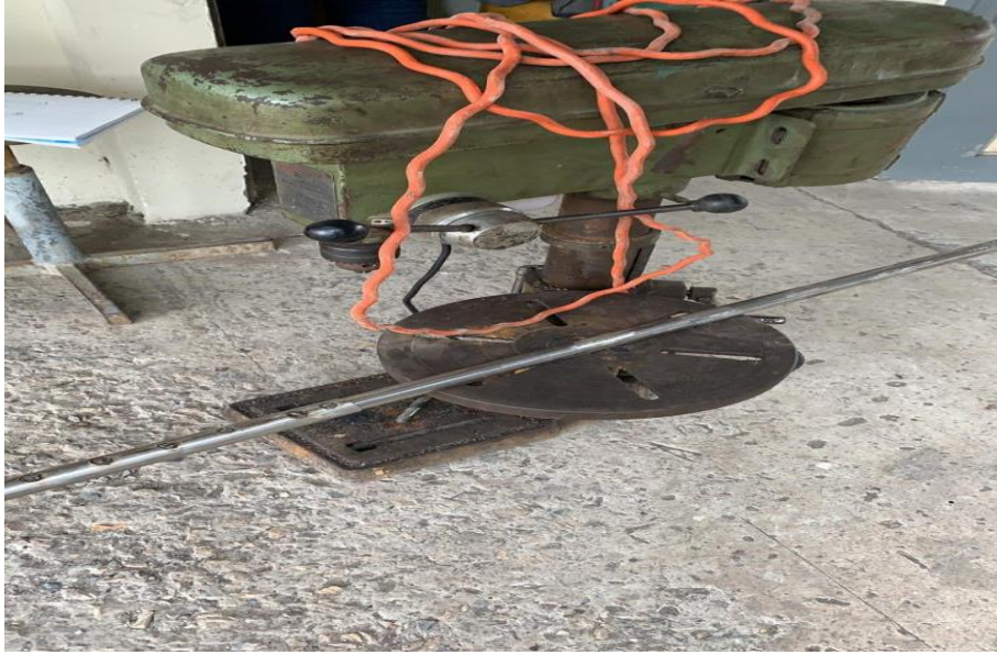
APENDICE A. 2 Perforación del eje para ubicar un prisionero. [Elaboración propia]
