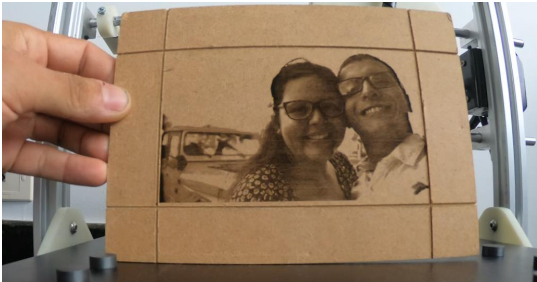
Figura D- 2 Grabado utilizando láser [Elaboración propia].
