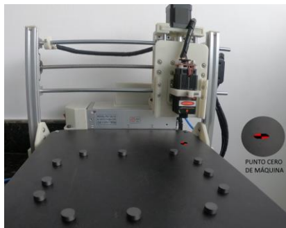
Figura 1.2 Punto cero de máquina representado sobre superficie metálica [Elaboración propia]
