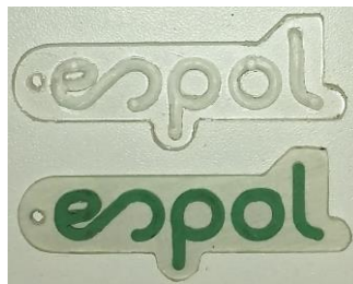
Figura 3.7 Grabado sobre acrílico y relleno con masilla [Elaboración propia].
