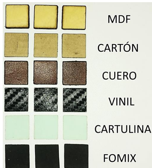
Figura 3.5 Corte por láser realizado en diferentes materiales [Elaboración propia].
