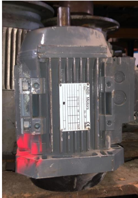
Figura A.16 Motor jaula de ardilla Trifásico de 3 [Hp] 220 [Vac]. [Elaboración propia]
