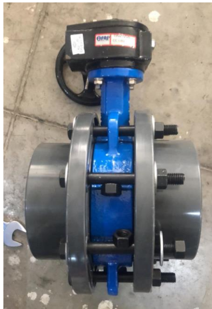
Figura A.14 Válvula mariposa con bridas PVC de 160 [mm]. [Elaboración propia]
