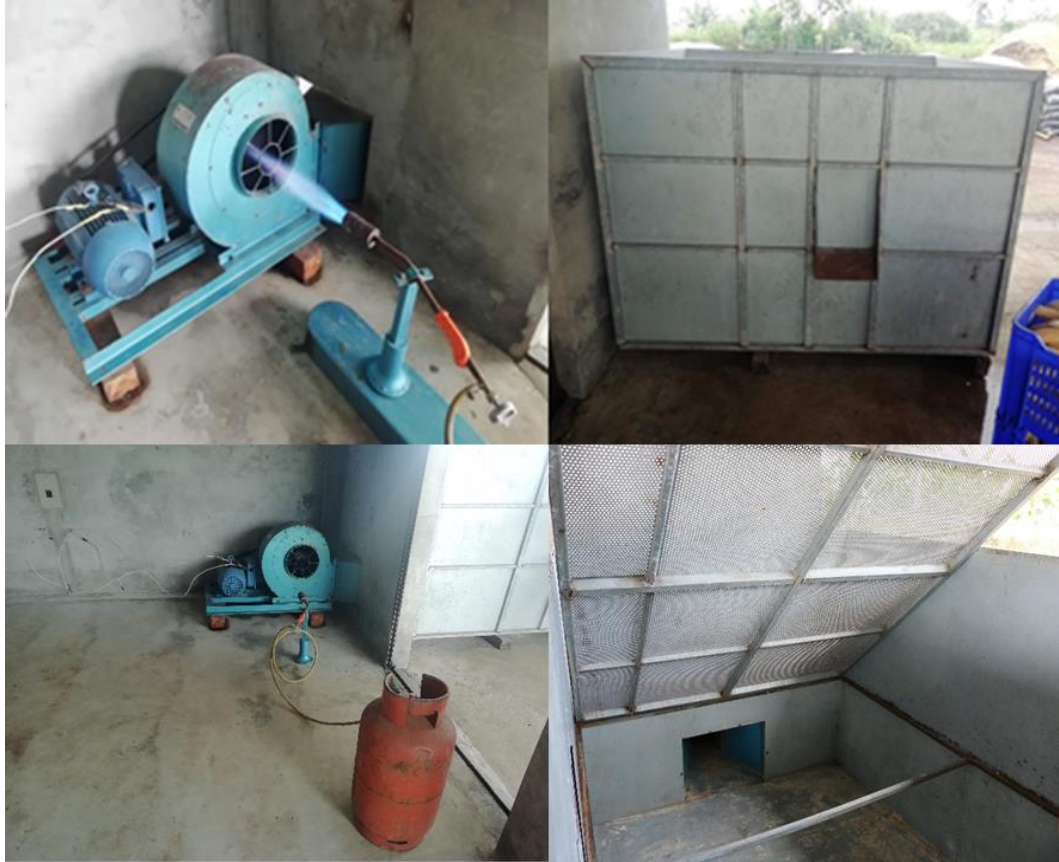
Figura 3.1: Secador de lecho fijo o estacionario. (Instalaciones CORPICSUPAL)
