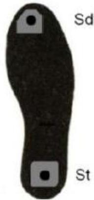
**Figura 2.4 Colocación de los sensores dentro de la planta del pie.
