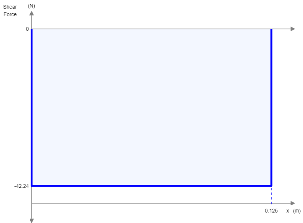
Figura A.9. Diagrama de fuerza cortante Fuente: SkyCiv
