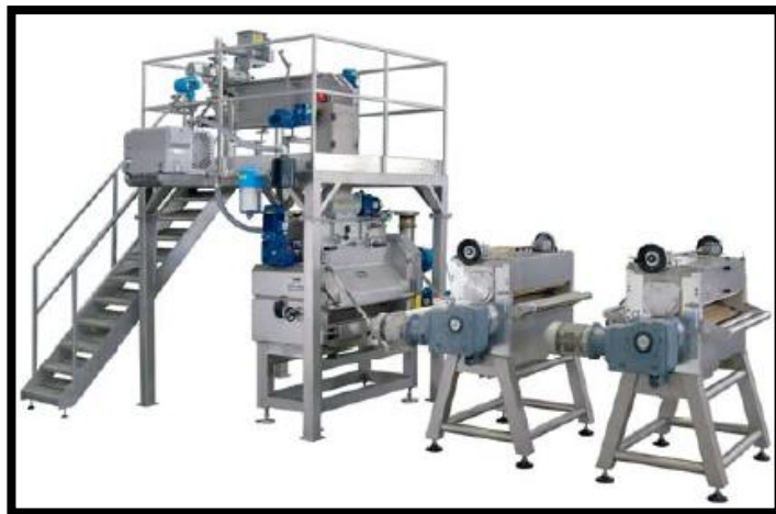
Figura 1.2 Sistema de elaboración de pasta fresca con proceso de mezclado, compactado y doble laminación. [Storci spa]
