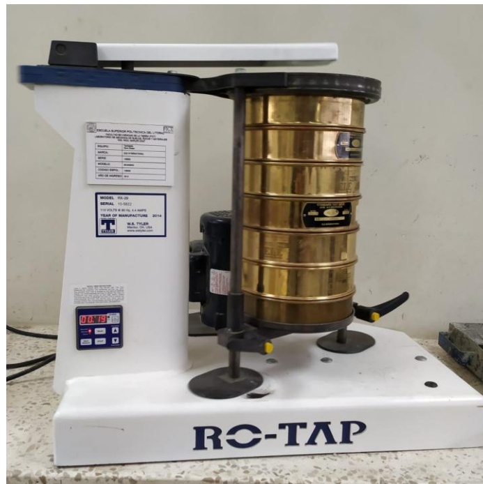
Figura 2.5 Tamizado de la muestra en seco, en una torre de tamices por medio de agitación mecánica. Autores: Pinales & Pozo.
