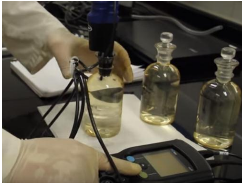
Figura 2.9 Lectura del oxígeno disuelto en botella winkler con muestra de agua tratada de la planta piloto de filtros verdes en la comuna Libertador Bolívar. Autores: Parrales & Pozo.
