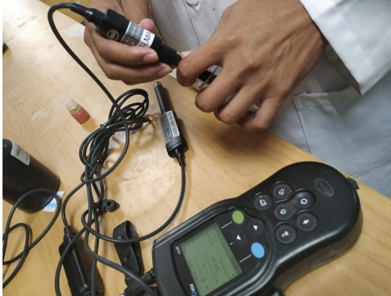
Figura 2.6 Determinación de conductividad eléctrica y pH de la muestra de suelo a través de electrodos. Autores: Parrales & Pozo.
