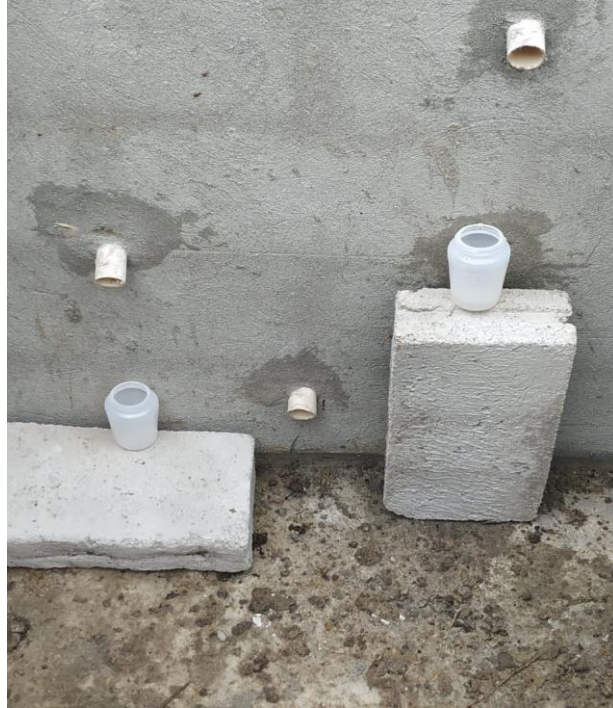
Anexo 2.E. Lisímetro en funcionamiento y toma de muestra de agua tratada por el sistema de filtros verdes.
