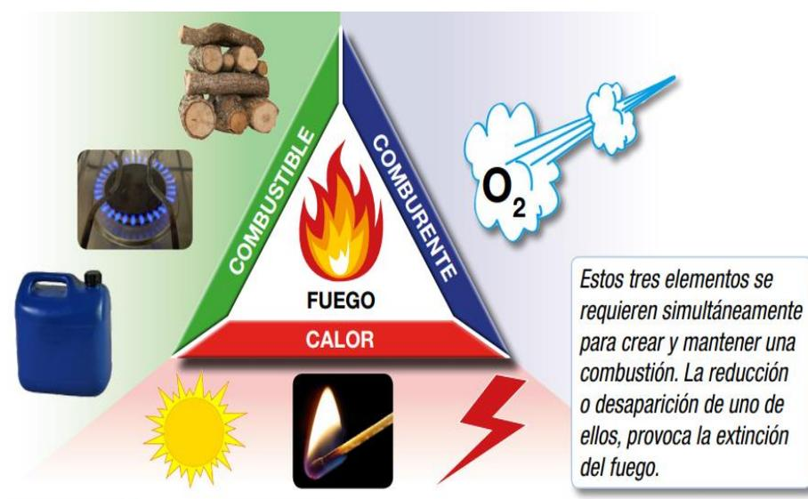
**Figura 1.1.1.1 Triángulo de Fuego**
