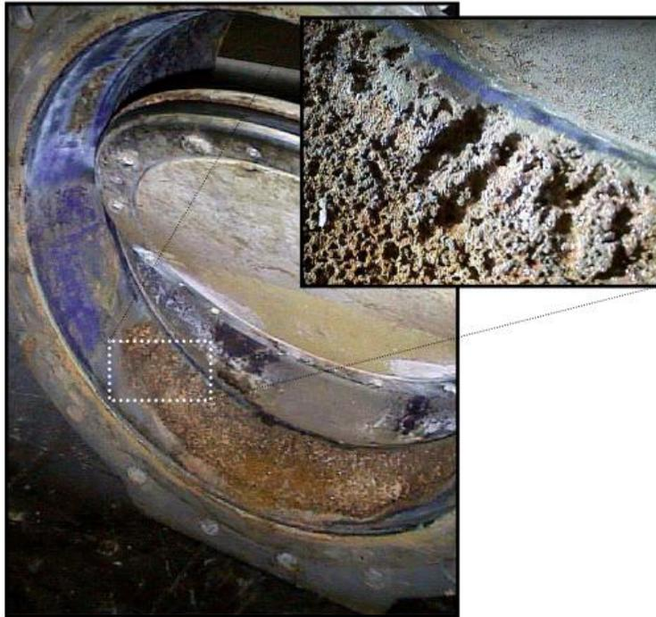
**Figura 1.3.7.2.5 Daños en accesorios por Cavitación**
