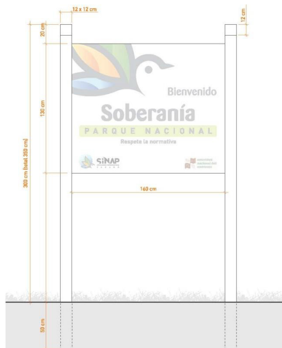
Figura 2. 4 - Presentación de montaje, medidas y diseño de señalética informativa e indicativa del Parque Nacional, los soportes son en madera Pinotea.
