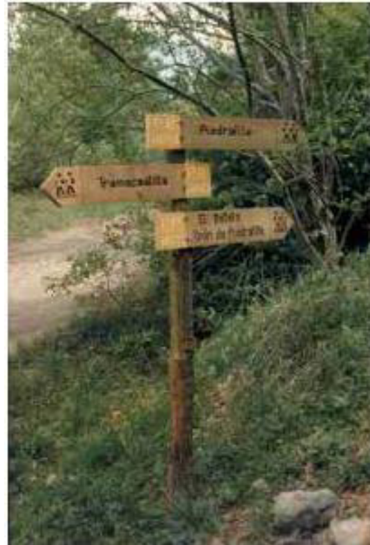
Figura 2. 6 - Señales turísticas de Aragón con la técnica de tallado de las letras e iconos señaléticos.
