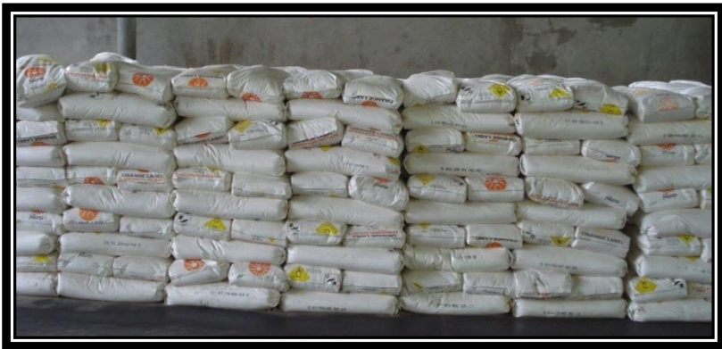
Figura 2.1.1: NITRATO DE AMONIO (Material utilizado para preparar el ANFO)
