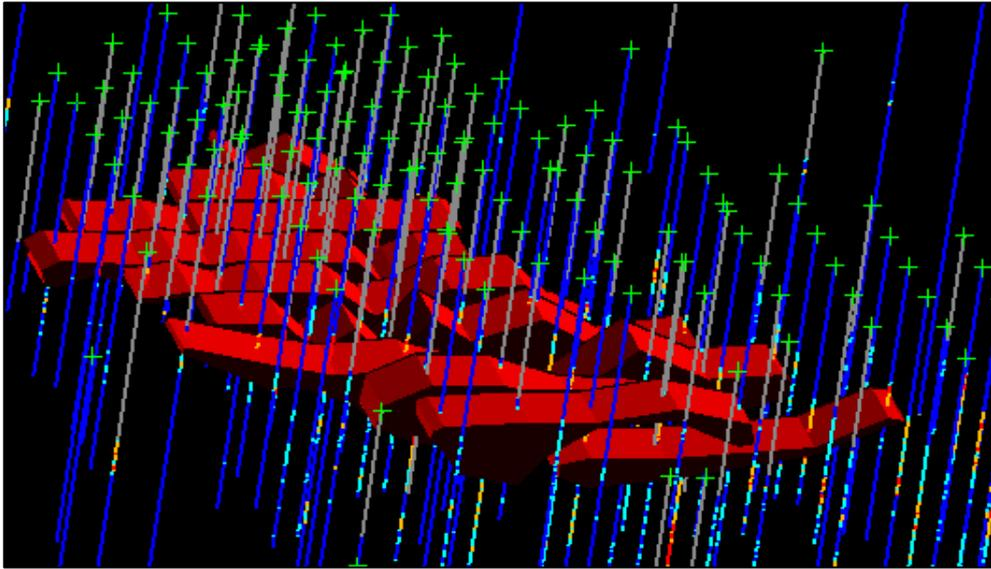
**Fig. 4-8:** Sólido generado a partir de la triangulación de las secciones interpretadas.
