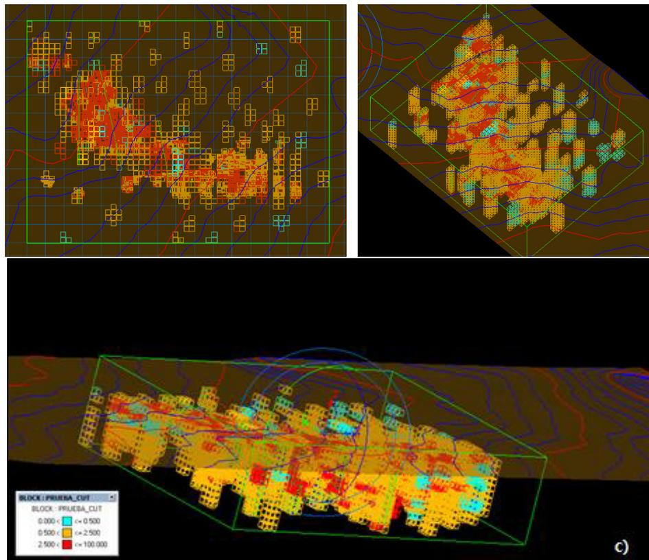
**Fig. 5-2:** Modelo de bloques tridimensionales con colores que representan los valores de las leyes. A) B) y C) muestran diferentes vistas del modelo de bloques creado.
