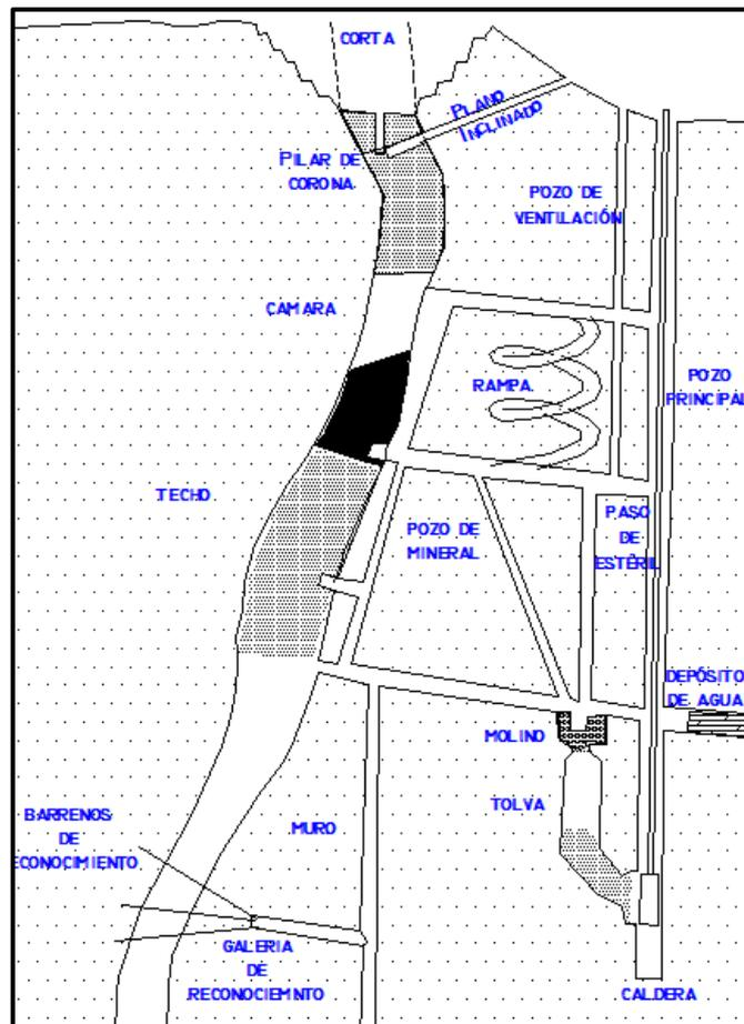
Fig. 2-11: Corte transversal de una explotación subterránea típica.
