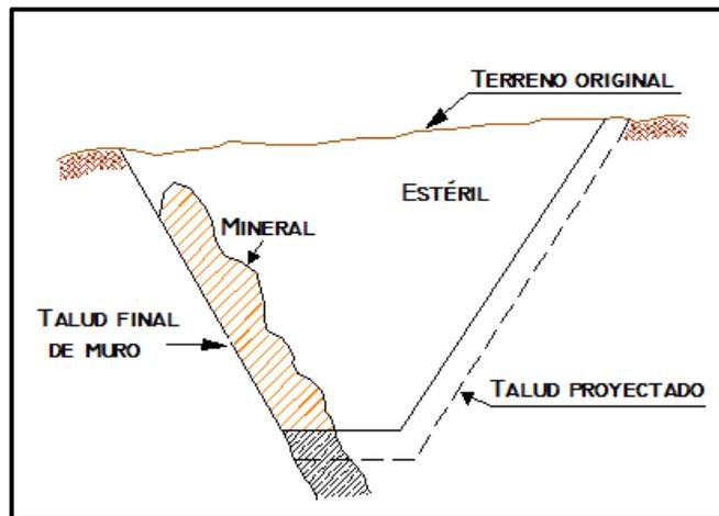
**Fig. 2-10:** Representación del ratio económico en una explotación a cielo abierto. (Fuente: Bustillo Revuelta, López Jimeno, 1997) Modificado (Tituana K., 2014)
