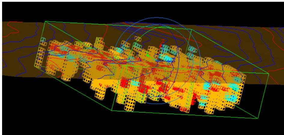
**Fig. 4-18:** Modelo de bloques, en donde cada color indica las concentraciones de cobre estimadas mediante el método del kriging. El color rojo representa las leyes más altas del depósito. (Fuente: Tituana K., 2014)
