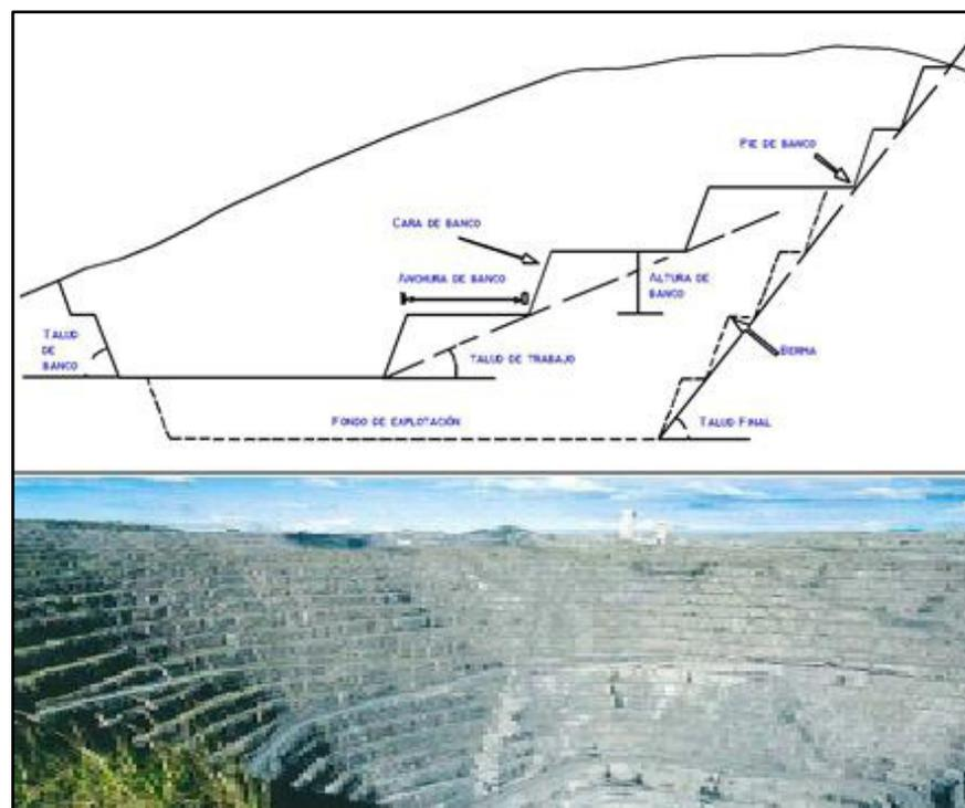
**Fig. 2-9:** Explotaciones a cielo abierto y parámetros principales de diseño.
