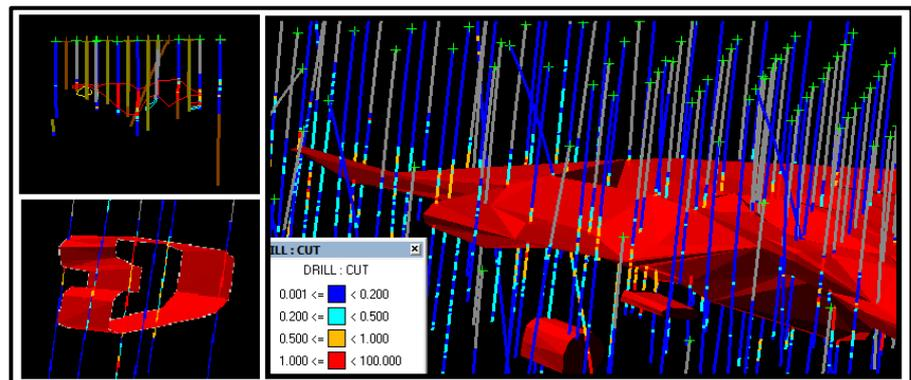
**Fig. 3-4:** Elaboración de los cuerpos sólidos. La esquina superior izquierda muestra una sección interpretada, en la parte inferior se encuentra parte de un sólido incompleto. La figura de mayor dimensión muestra un sólido completamente cerrado.
