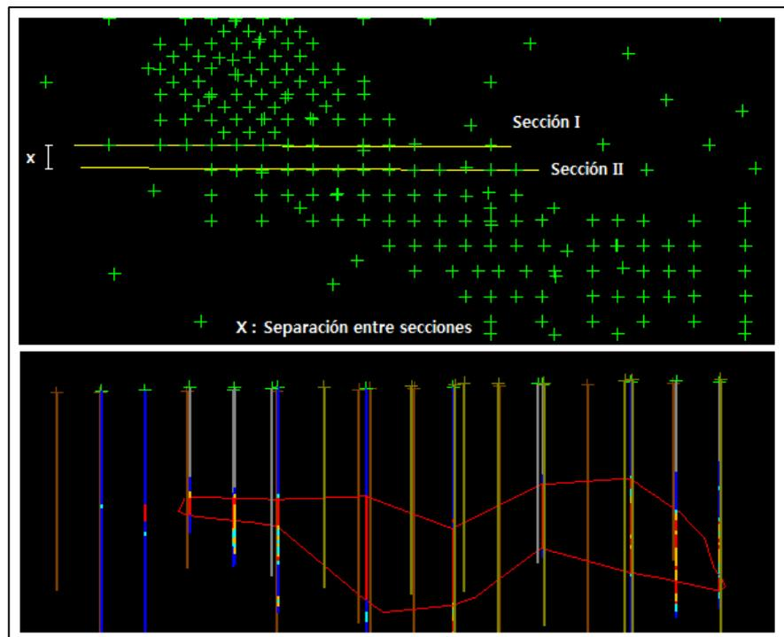
**Fig. 3-3:** La figura superior corresponde a la vista en planta de los sondeos desplegados con líneas transversales que representan dos secciones interpretadas en la figura inferior. (Fuente: Tituana K., 2014)
