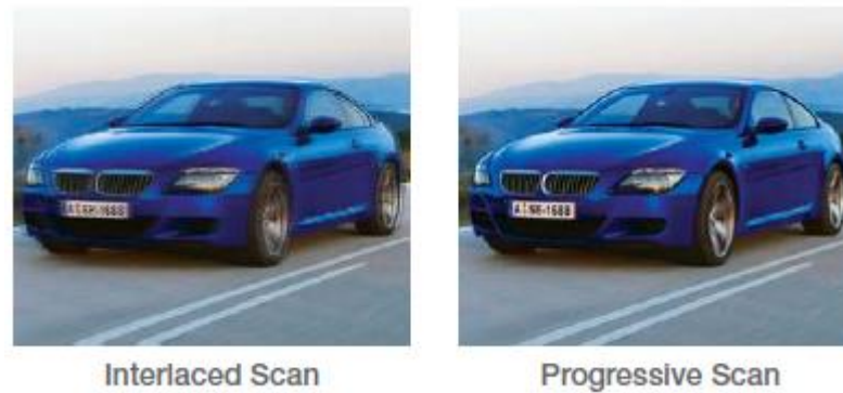
Figura2-21 Imagen comparativa entre Exploración Progresiva (der) y Entrelazada (izq)
