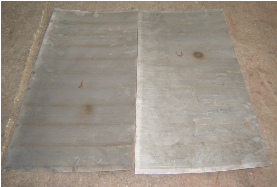
Figura 2-8. Mallas perforadas (cribas) para Molino de Martillos.
