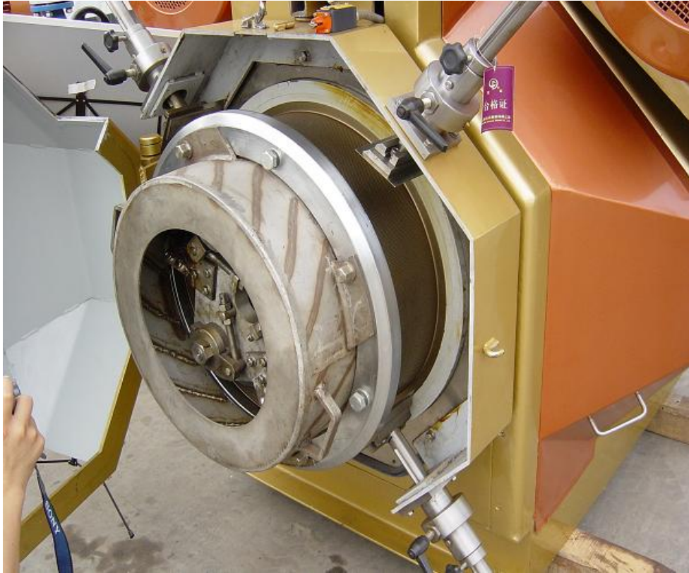
Figura 1-6. Pelletizadora para alimentos balanceados (cortesía Muyang Group)
