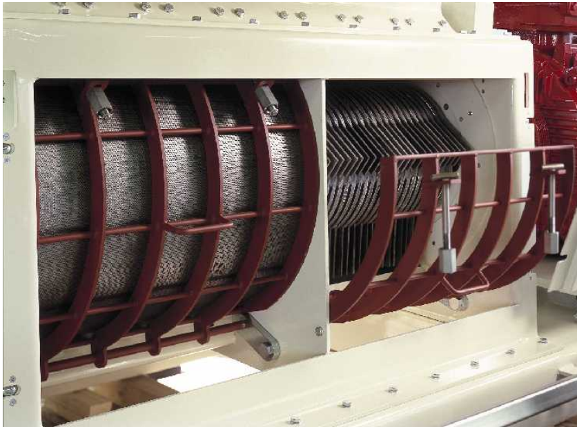
Figura 2-7. Molino de martillos con malla (cortesía Sprout Matador)
