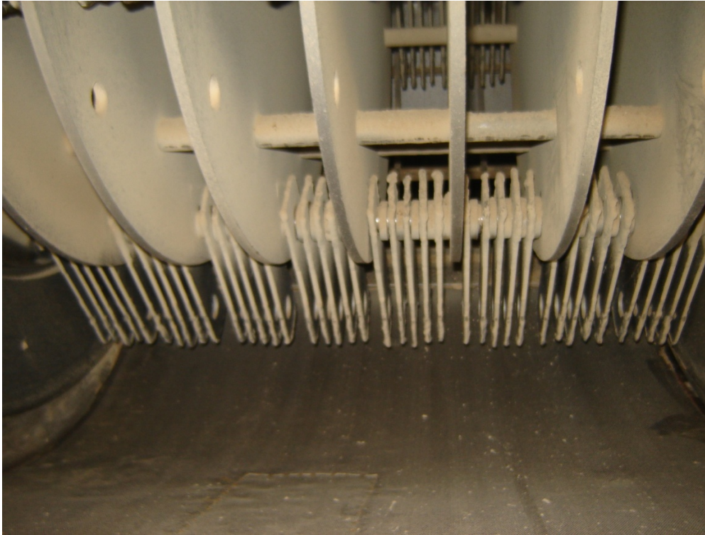
Figura 2-6. Distancia entre martillos y criba en Molino (cortesía de Alimentosa)
