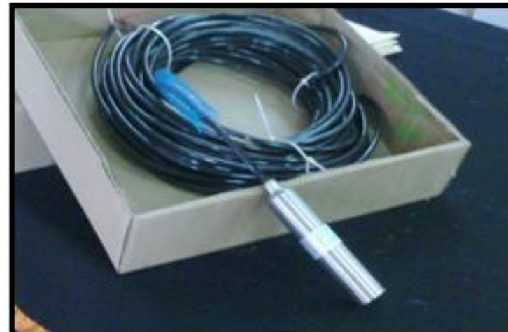
Sensor de nivel, que serán utilizados para las cisternas del CALIME-BIMESM-CUARTO DE BOMBAS
