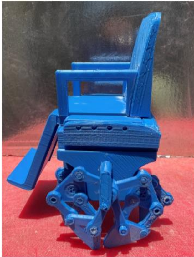
Figura: 3.33: Prototipo impreso con ABS
