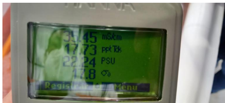
Figura D.37 Comprobación de la salinidad del sistema.
