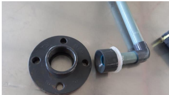
Figura D.18 Acoplamiento de brida y reductor PVC
