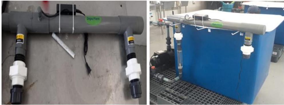
Figura 3.4 Filtro de lámpara UV y ubicación de en el Sistema. [Elaboración propia]
