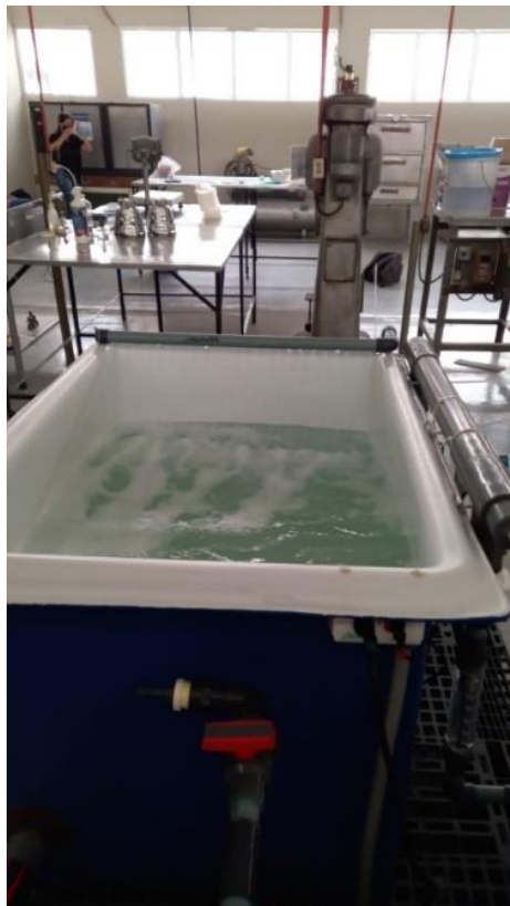
Figura D.31 Prueba de los aspersores a 20L/min
