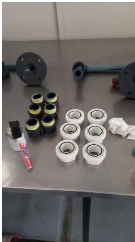
Figura D.15 Selección de accesorios para entrada y salida del UV.
