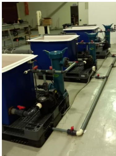
Figura D.29 Sistema de depuración funcional.
