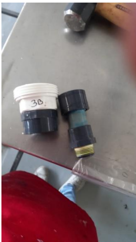
Figura D.12 Acoplamiento de accesorios PVC
