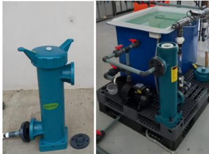
Figura 3.3 Filtro de sedimentación y su respectiva ubicación en el Sistema [Elaboración propia]
