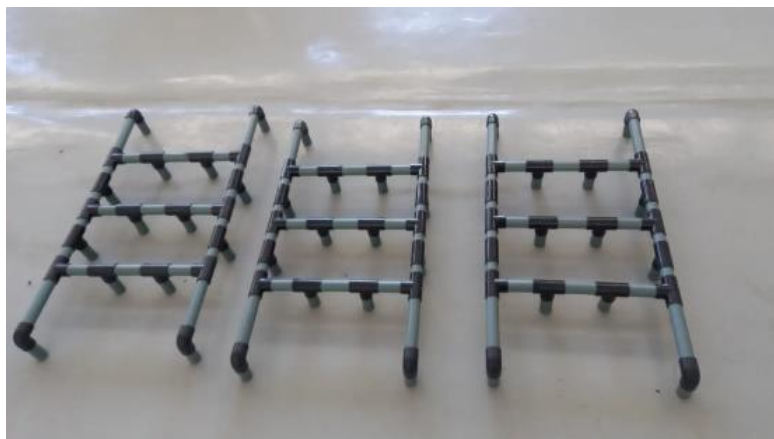
Figura D.24 Emparrillado del sistema depuración.
