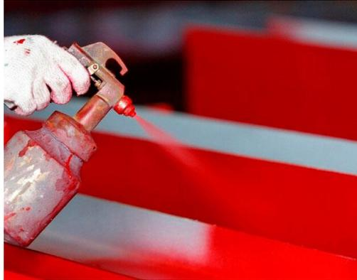
**Figura 1.3 Aplicación de pintura con pistola con mezcla de aire**
