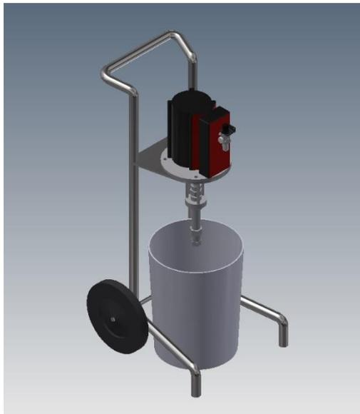
**Figura 3.1 Estructura con la bomba y simulación de un balde de pintura.**
