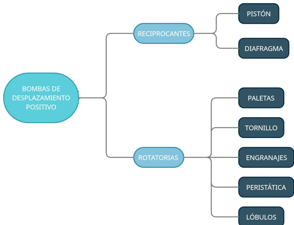
Figura 1.6 Clasificación de las bombas de desplazamiento positivo
