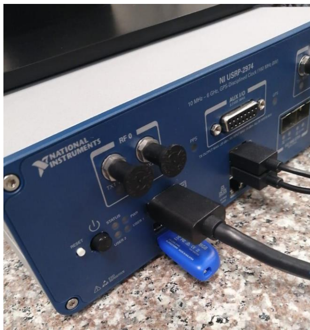
Figura 3.7 Pendrive insertado en el NI USRP
