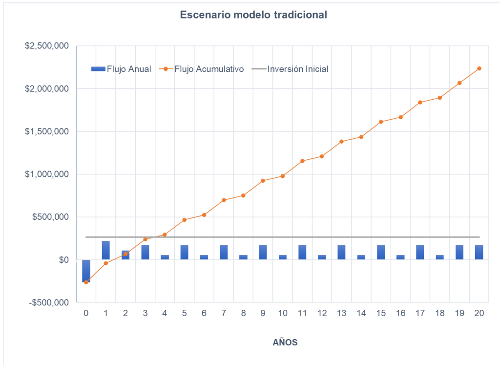
Figura 3.9 Recuperación de inversión para el modelo con sistema de propulsión tradicional
