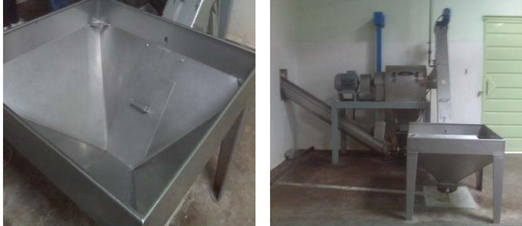
Esta máquina receptorá la masa de aguacate, donde será extraído el aceite, luego pasará a otra similar para su respectiva refinación; culminando este proceso el aceite será transportado por unas tuberías que conllevan el líquido hacia unos tanques de metal inoxidable para luego pasar al embotellado, sellado y etiquetado.
