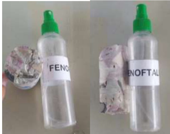
Ilustración 17 Ensayo de carbonatación en núcleo extraído.
