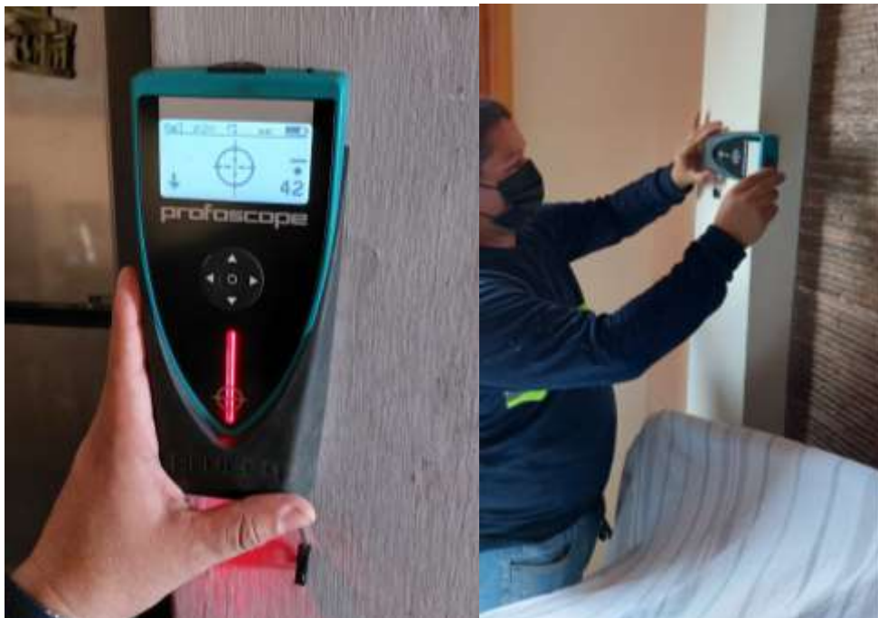
Ilustración 15 Toma de ensayos con Pachometro
