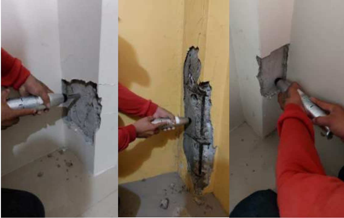
Ilustración 13 Toma de ensayos con esclerómetro
