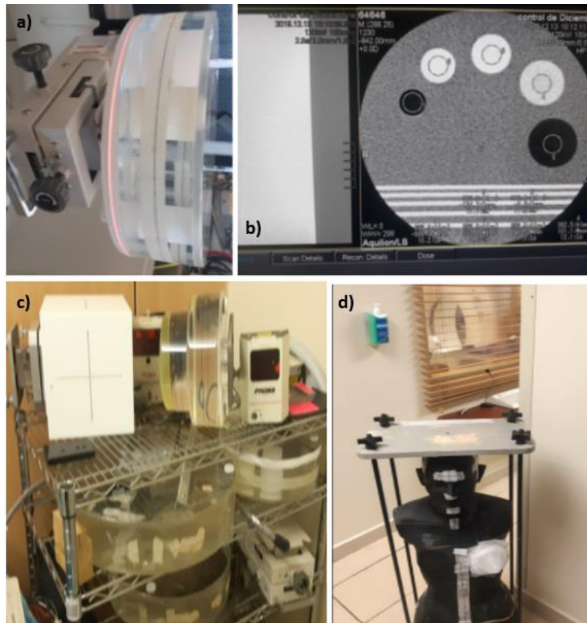
Figura 4.40 Fantomas de control: a) Fantoma de densidades b) Comprobación de números CT c) Fantoma de agua d) Fantoma de cuerpo completo.
