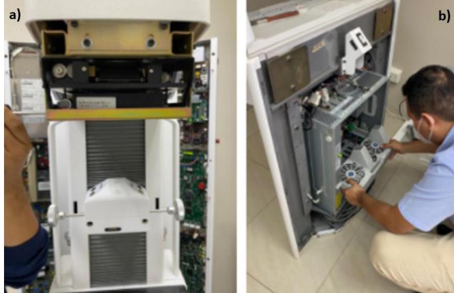
Figura 4.20 Proceso de instalación del mamógrafo a) Gantry b) Consola
