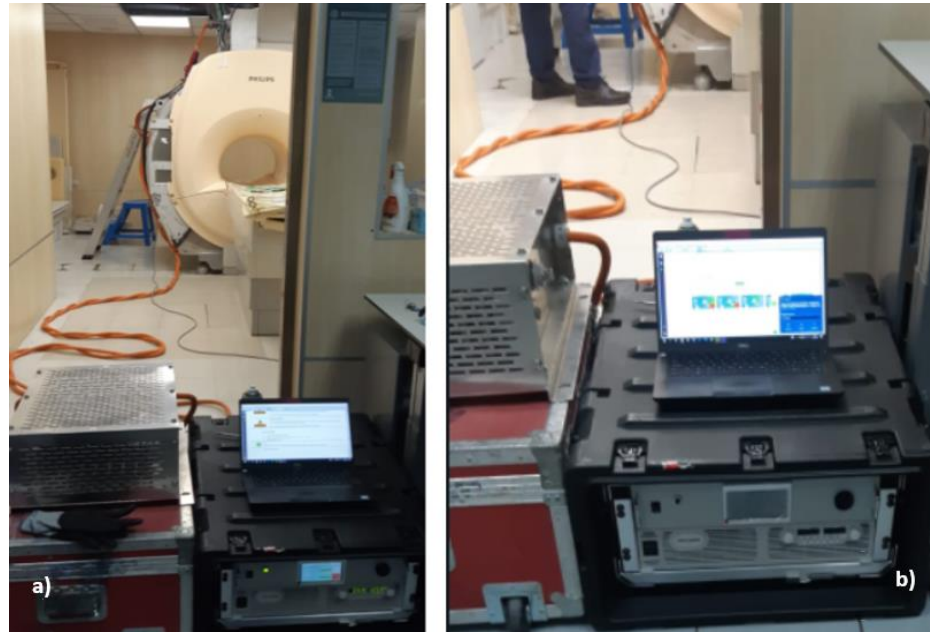
Figura 4.32 Encendido del campo magnético a) Alimentación de corriente a la bobina b) Fuente de corriente externa para el control del encendido
