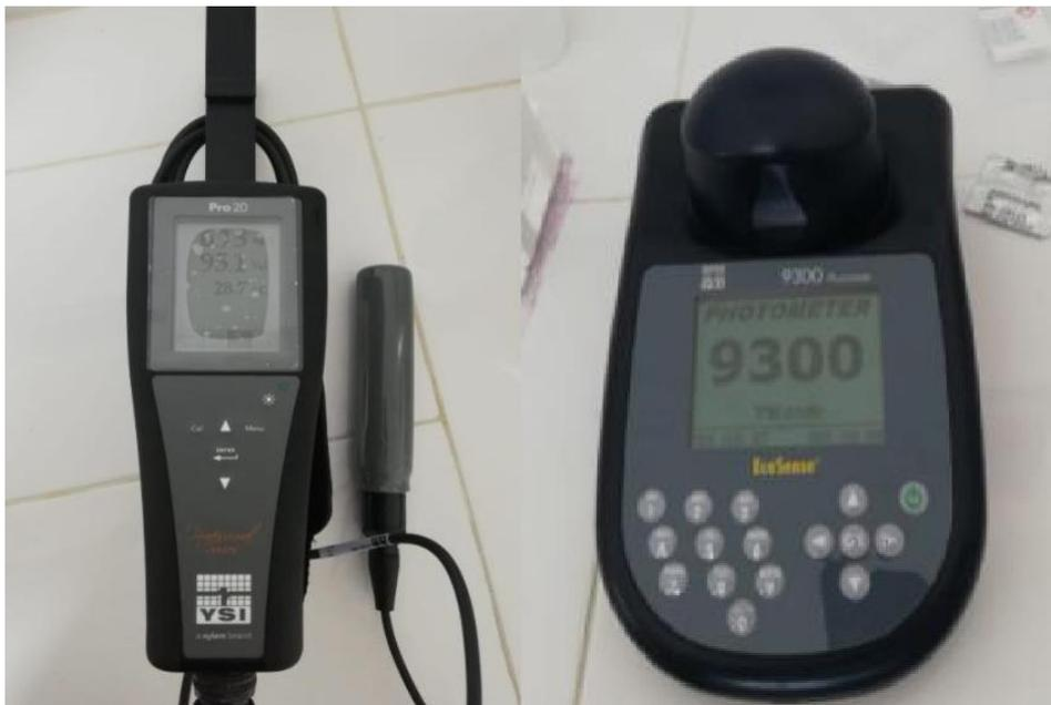
*Imagen 4. Equipos de Oxigenómetro y fotómetro para realizar análisis de los parámetros fisicoquímicos.*
