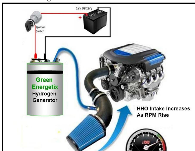
Ilustración 4.52 Generador de hidrógeno
