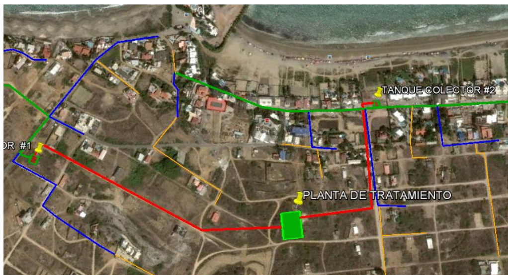
Imagen 3. 5 LÍNEAS DE CONDUCCIÓN Y BOMBEO DE AGUAS SERVIDAS
