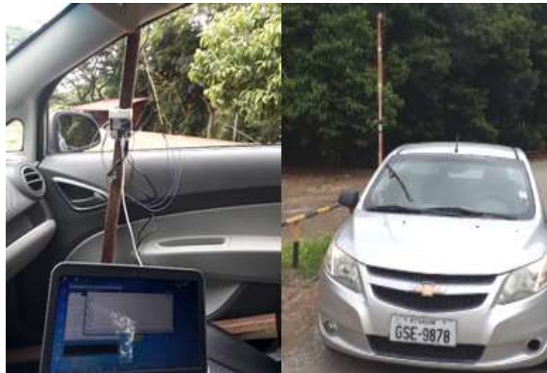
Figura 4.2: Ubicación de Xbee a altura aproximada de 3 metros
