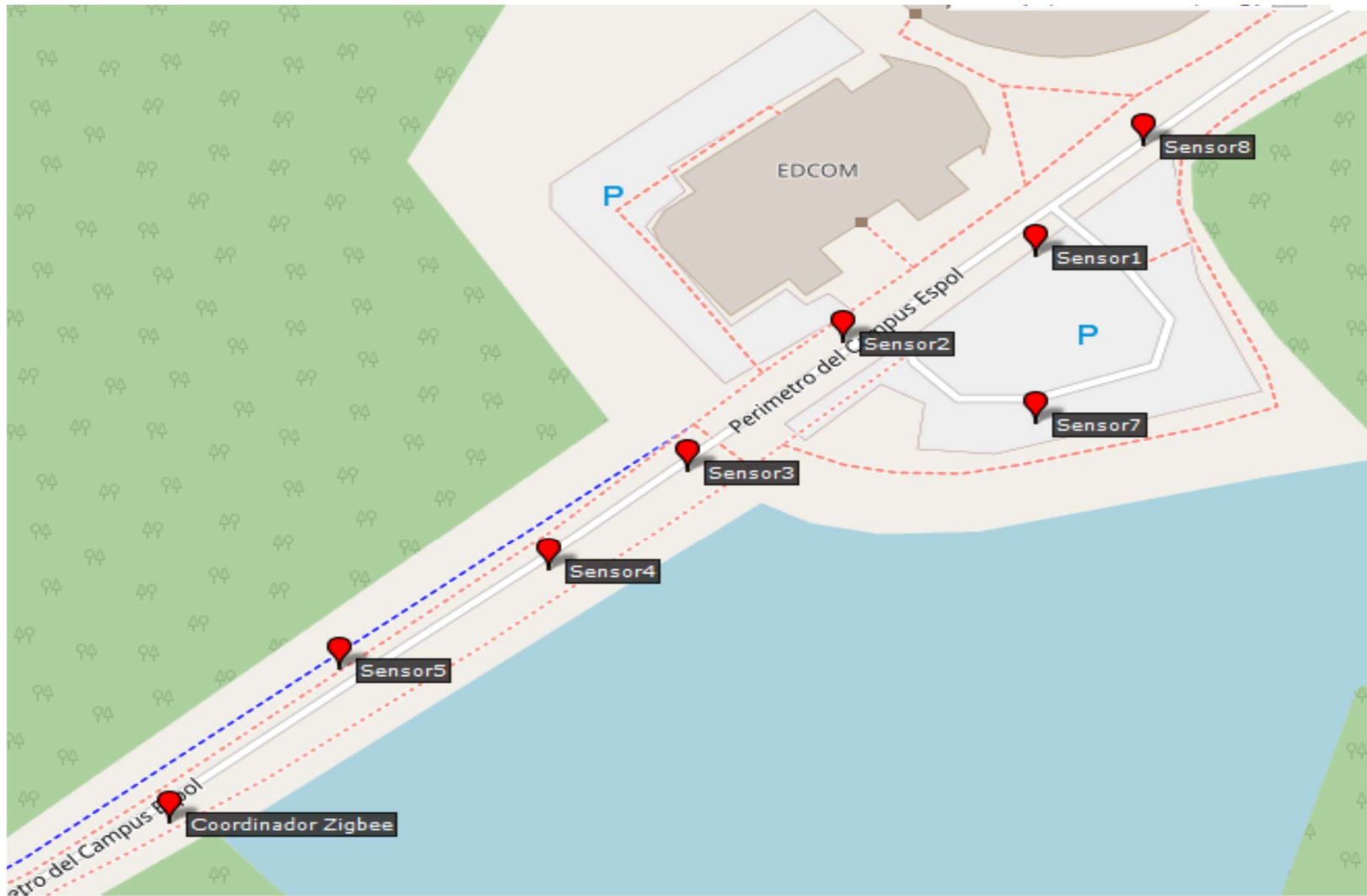
Figura 4.10: Ubicaciones de Nodos Sensores y Nodo Coordinador para pruebas de Delay y Jitter
