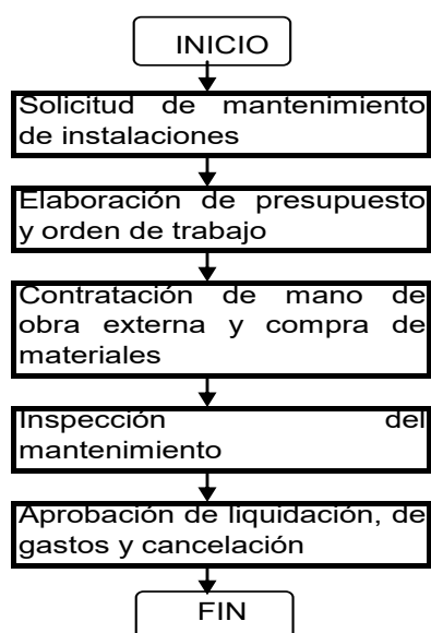
Figura 3.4 Diagrama de flujo del proceso actual de “mantenimiento”
