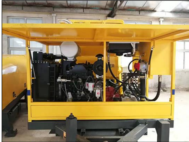
Figura A 12 Cubierta de la bomba con su compuerta abierta
