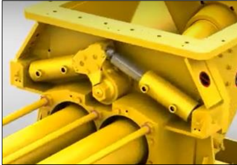
Figura A 7 Sistema de pistones que mueven la válvula S ( Putzmeister, Putzmeister: KOS double piston pump, 2019 )
