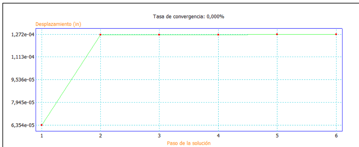
Figura 3.26 Convergencia en el desplazamiento del vstago del pistn para una carga de 500 N (Elaboracin propia)
