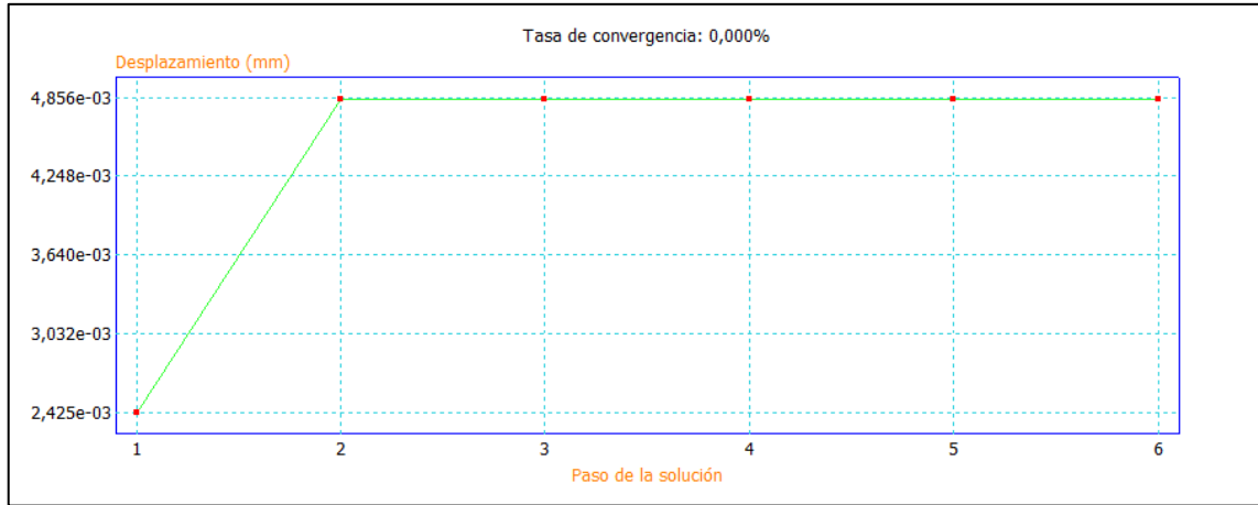
Figura 3.9 Convergencia en el desplazamiento del soporte del pistón para una carga de 32.83 N (Elaboración propia)
