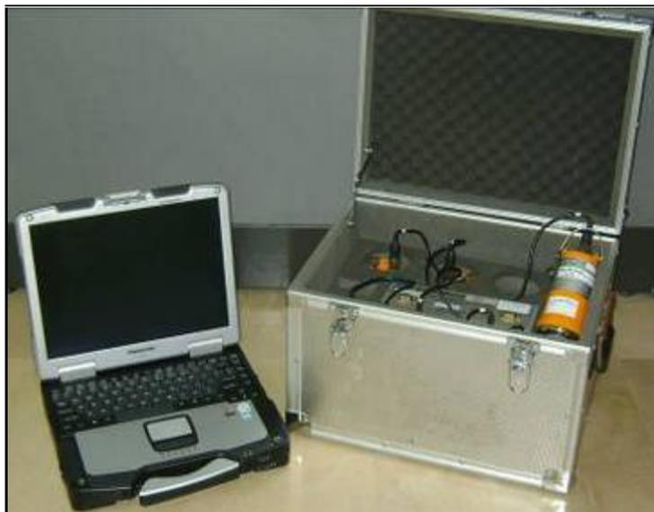
Correlador multidireccional SoundSens, set de 6 CP logres, unidad central para programación y descarga de datos, y computadora portátil utilizada para la descarga y análisis de datos de correlación.
