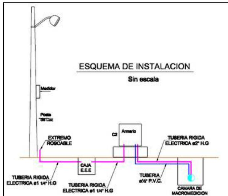
Figura 8. Esquema de instalación para puntos de macromedición
