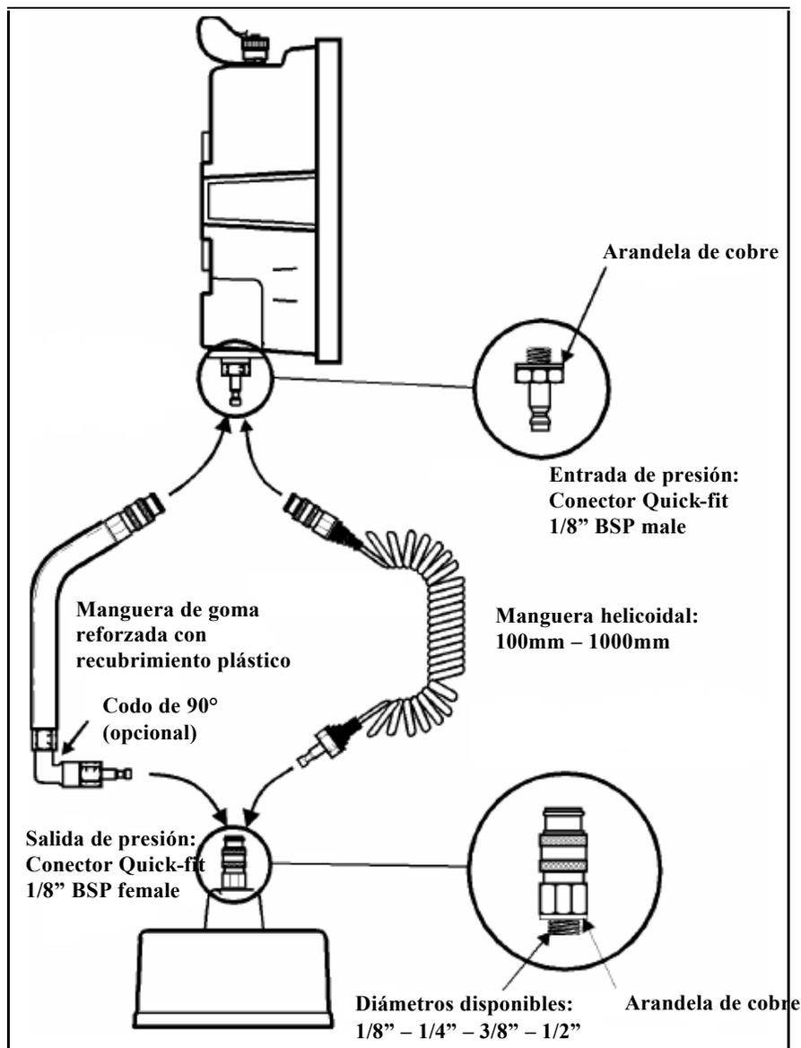
Figura 9. Esquema de conexión para entrada de medición de presión de servicio en data-logger
