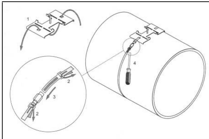
Figura 11. Esquema de instalación de abrazaderas inoxidables para fijar sensores de caudalímetro ultrasónico en tuberías de diámetro mayor a 500mm.
