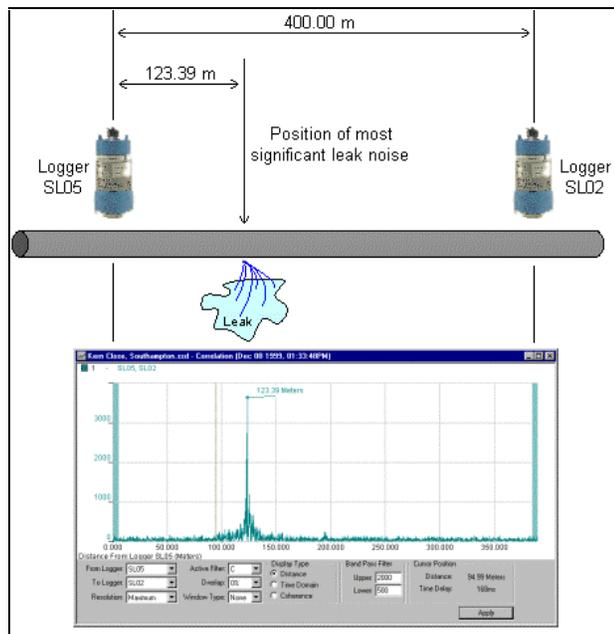
Esquema de ubicación de loggers y gráfico de correlación de una fuga detectada utilizando 2 CP loggers del correlador multidireccional SoundSens
