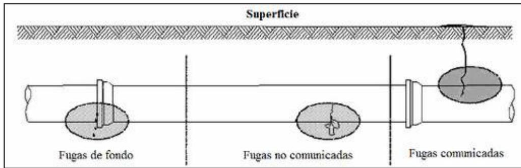
Figura 2. Clasificación de las fugas realizada por Lambert, Mayers y Trows en 1998
