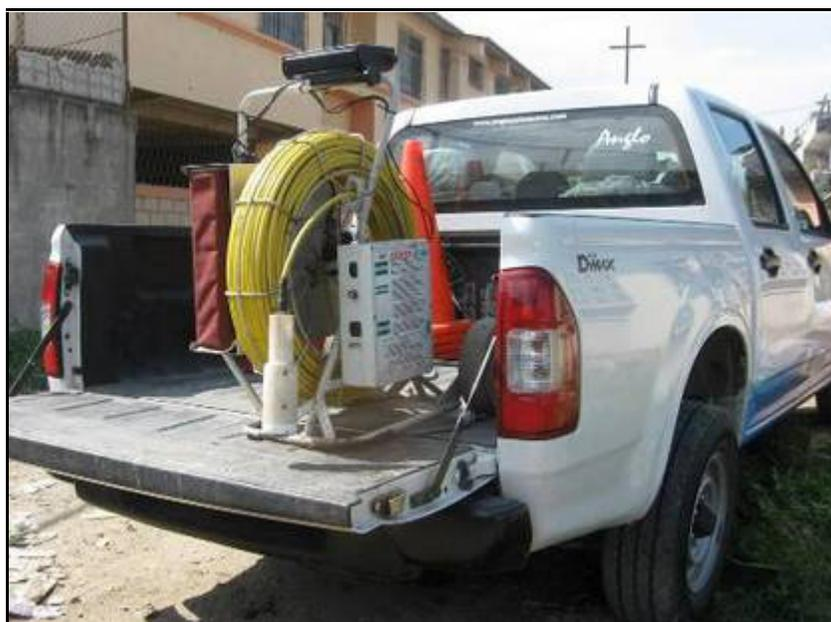
Cámara de video-inspección portátil Sekeer utilizada durante la materialización de la sectorización hidráulica de la red de AA.PP. del Suburbio Oeste.
