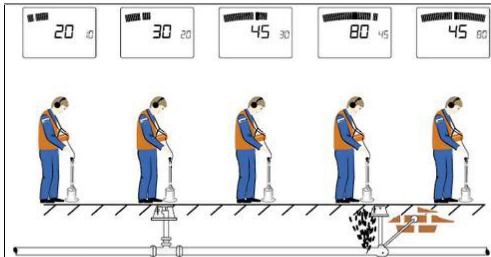
Figura 23. Localización de una fuga con la utilización de micrófono de campana.
