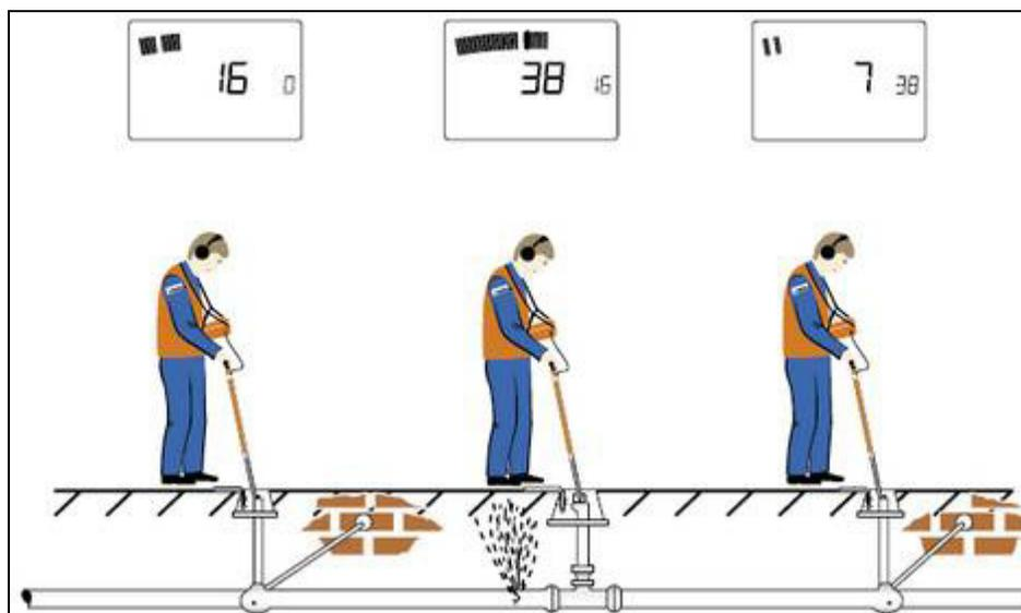
Figura 22. Prelocalización de una fuga con la utilización de la varilla de contacto.
