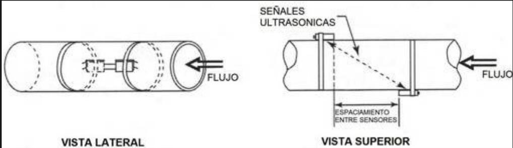
Método de instalación Z para sensores de fijación externa de caudalímetro ultrasónico.
