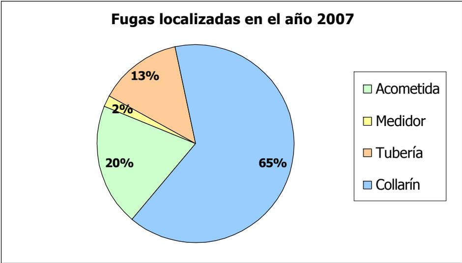
Desagregación de las fugas visibles y no visibles localizadas en la red de distribución de AA.PP. del suburbio oeste, año 2007
