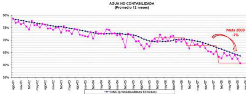
Figura 35. Evolución del Índice de Agua No Contabilizada en el sistema de distribución de AA.PP. de la ciudad de Guayaquil para el período comprendido entre enero del 2001 y octubre del 2008. (Fuente: Gerencia de Distribución de agua potable y alcantarillado, Interagua C. Ltda.)
