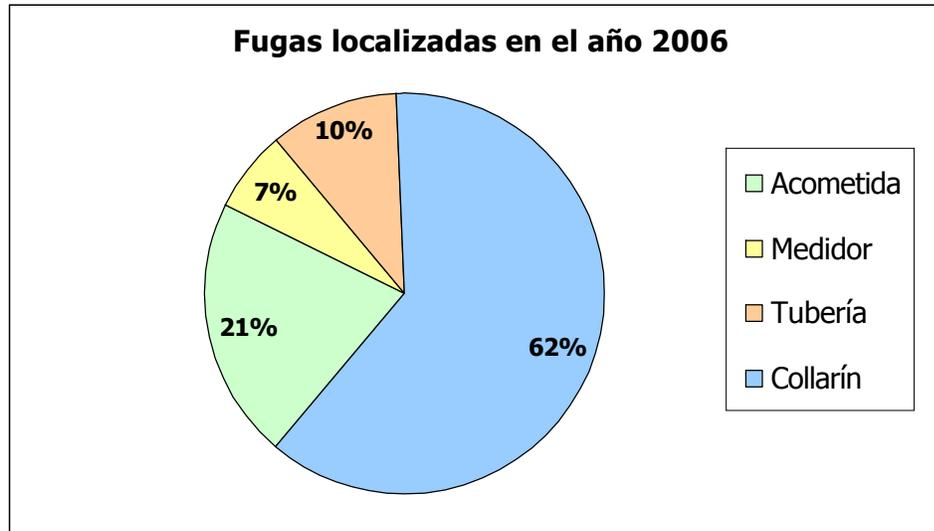
Desagregación de las fugas visibles y no visibles localizadas en la red de distribución de AA.PP. del suburbio oeste, año 2006
