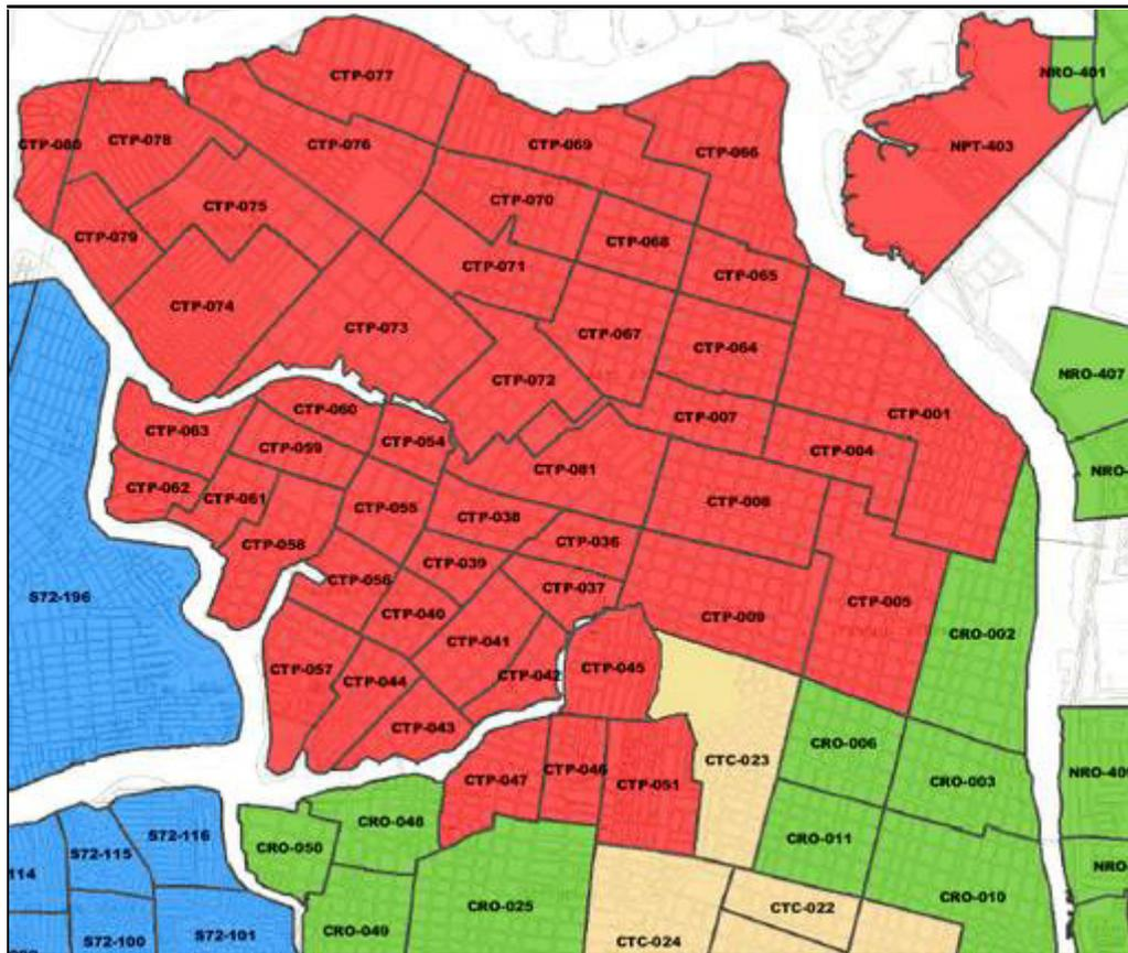
Figura 6. Sectorización hidráulica de la red de distribución de AA.PP. del Suburbio Oeste.
