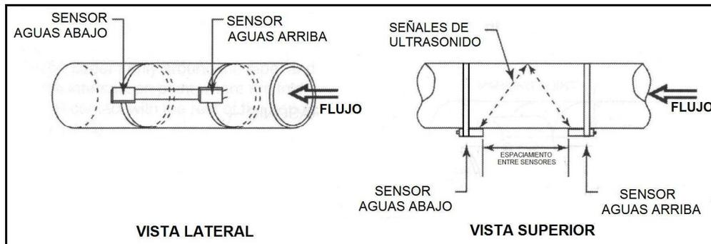
Método de instalación V para sensores de fijación externa de caudalímetro ultrasónico.
