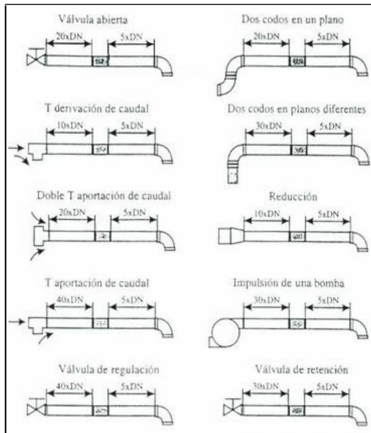
Distancias requeridas aguas arriba y aguas abajo para la instalación de caudalímetros
