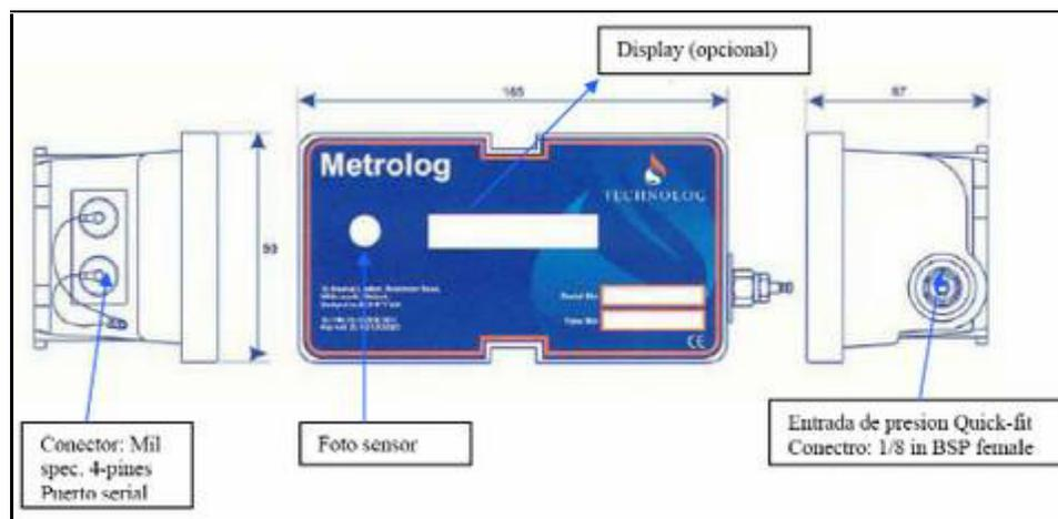
Figura 10. Esquema de puertos de entrada y salida de datos en data logger Metrolog P.
