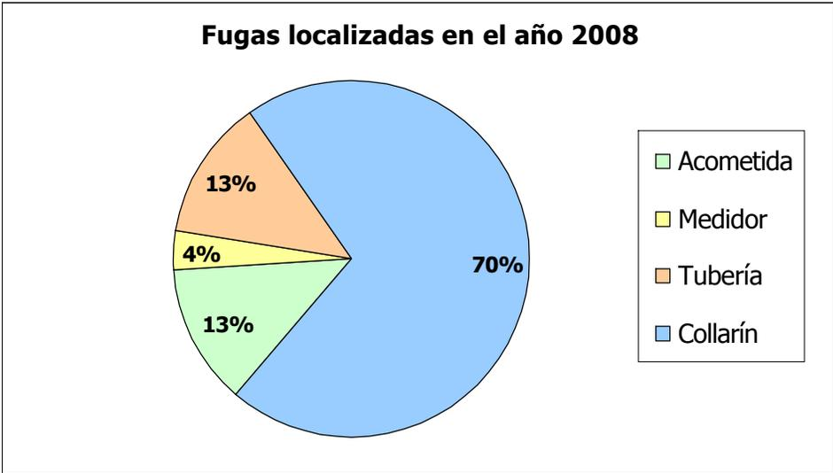
Desagregación de las fugas visibles y no visibles localizadas en la red de distribución de AA.PP. del suburbio oeste, año 2008
