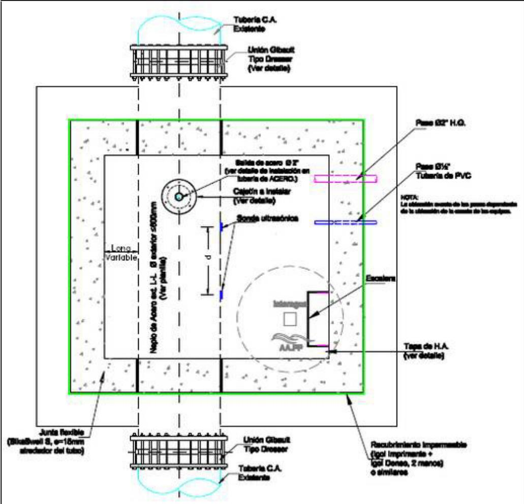
Vista superior - Cámara de medición (tipo II) y accesorios
