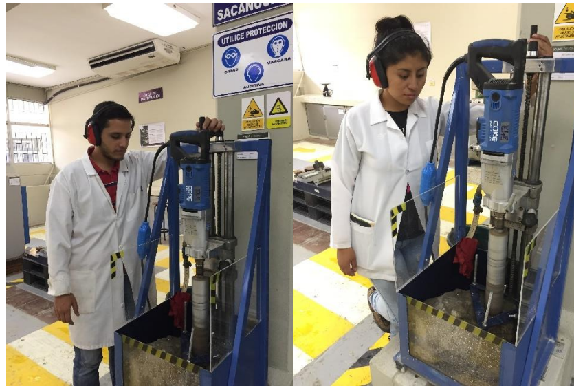
Figura 2.2 Extracción de núcleo de roca [Autores, 2019]
