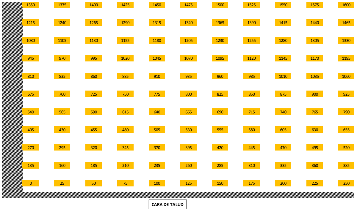
Figura 3.17 Secuencia de voladura para los bancos 5, 4 y 3 [Autores, 2019]
