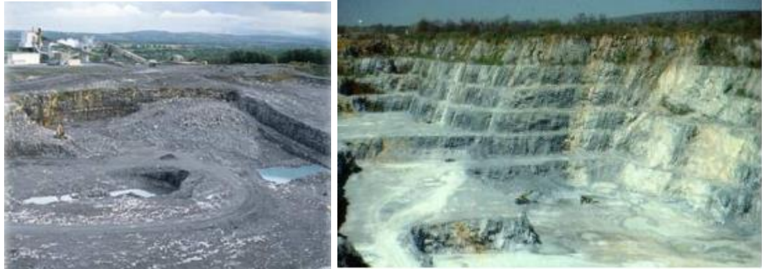
Figura 1.12 Cantera en terreno horizontal, trinchera de apertura (izquierda), bancos (derecha) [Herrera, 2006]
