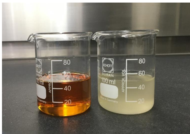
Figura 3.6 Resultado de ensayo de presencia de impurezas orgánicas en la muestra de árido fino [Autores, 2019]
