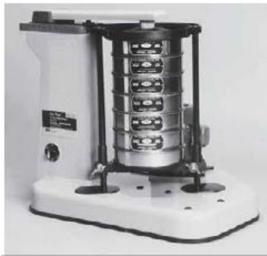
Figura 1.6. Conjunto de tamices para pruebas en laboratorio. Fuente: (Braja M., 2001)
