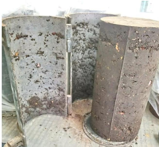
**Figura 16. Desencofrado de los cilindros.**
