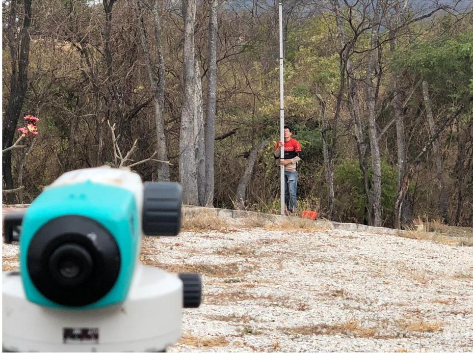
**Figura 4. Nivelación arrastrando la cota de los hitos respectivos.**
