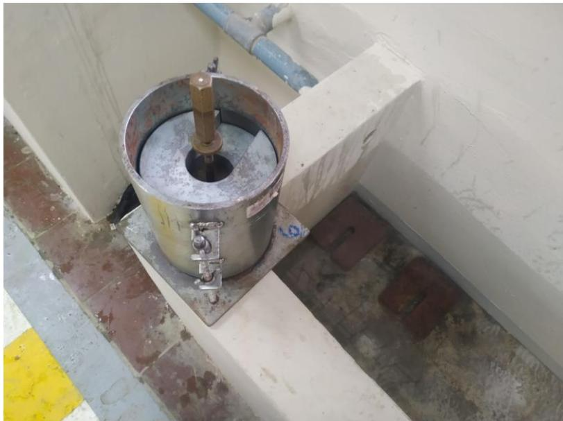
**Figura 13. Sumersión de los cilindros de CBR en la piscina.**
