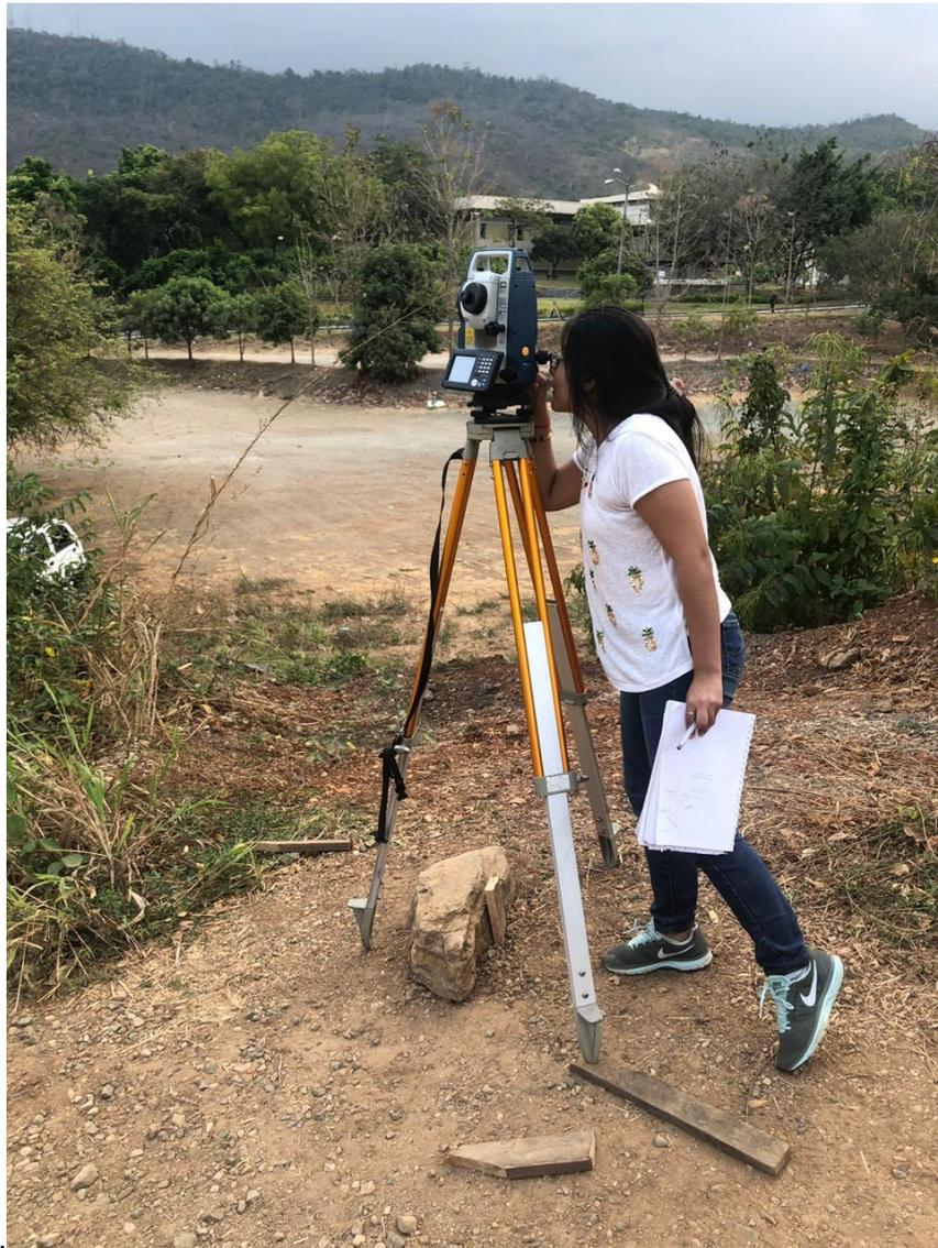
**Figura 3. Calado de la estación para realizar las respectivas triangulaciones.**
