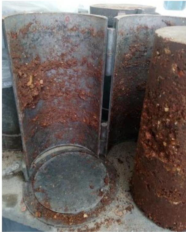
**Figura 3.9. Desencofrado de cilindros de suelo-cemento.**
