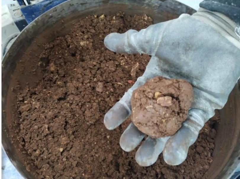
**Figura 15. Mezcla de suelo cemento, prueba de campo de humedad óptima.**
