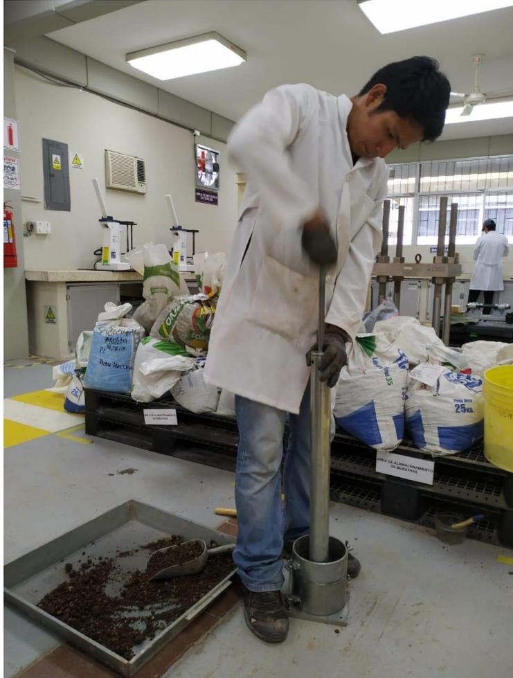
**Figura 12. Elaboración del ensayo de Proctor modificado.**
