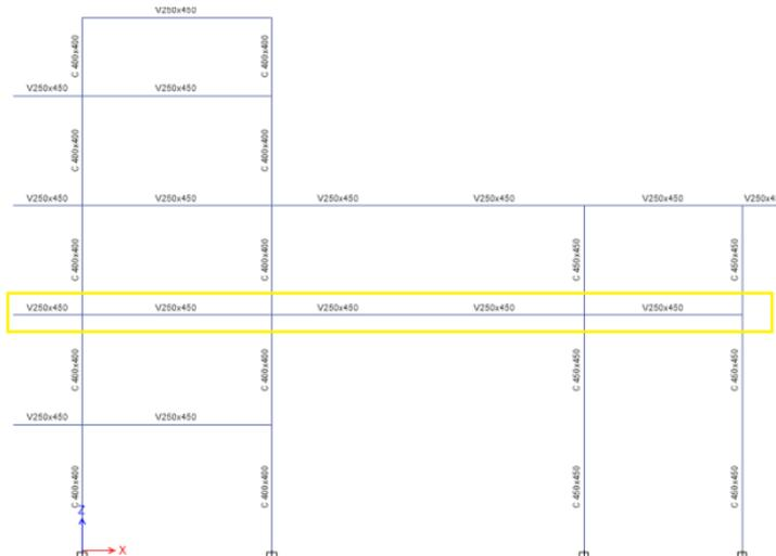
**Diseño para las vigas del segundo nivel  $b_w = 250 \text{ mm}$  y  $h = 450 \text{ mm}$**
