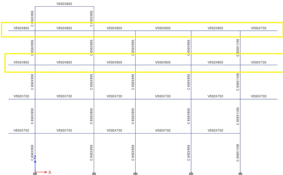
**Diseño para las vigas del tercer y cuarto nivel  $b_w = 500 \text{ mm}$ ,  $h = 600 \text{ mm}$**
