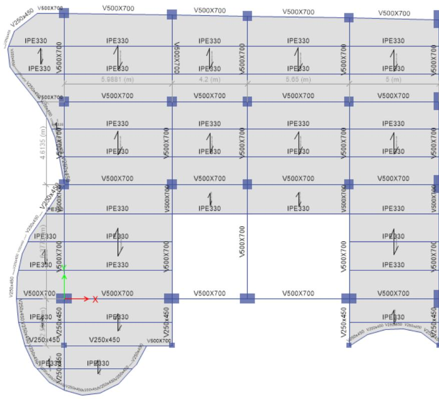
**Figura 0.10 Asignación de vigas principales y secundarias del primer nivel (Bravo y Falconez, 2020)**
