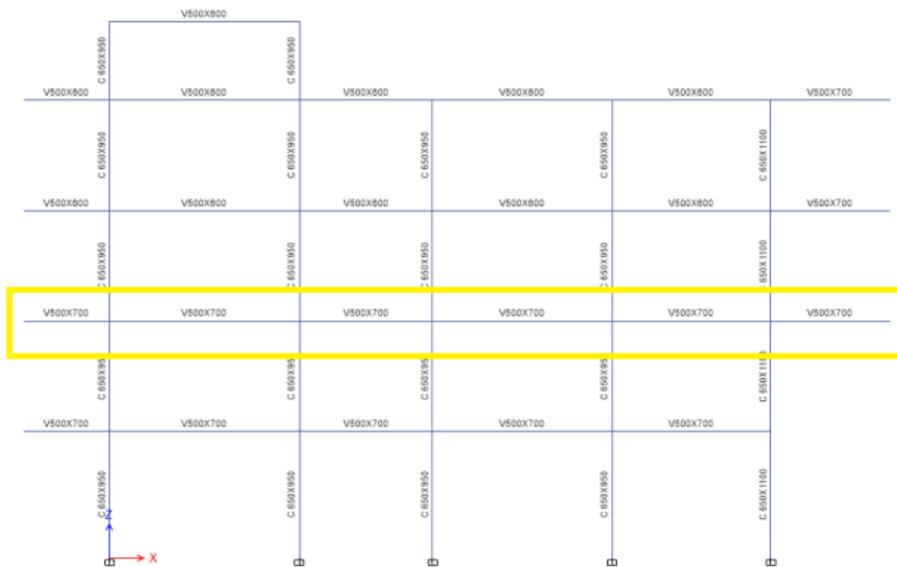
**Diseño para las vigas del segundo nivel  $b_w = 500 \text{ mm}$ ,  $h = 700 \text{ mm}$**
