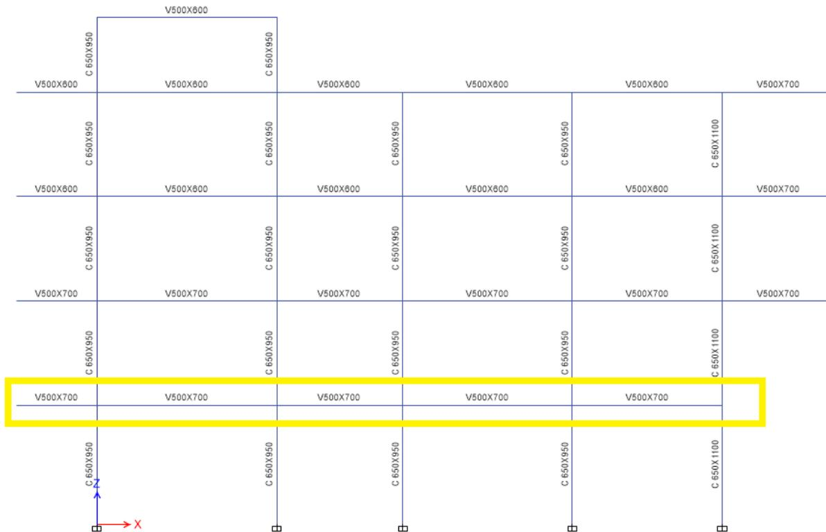
**Diseño para las vigas del primer nivel  $b_w = 500 \text{ mm}$ ,  $h = 700 \text{ mm}$**
