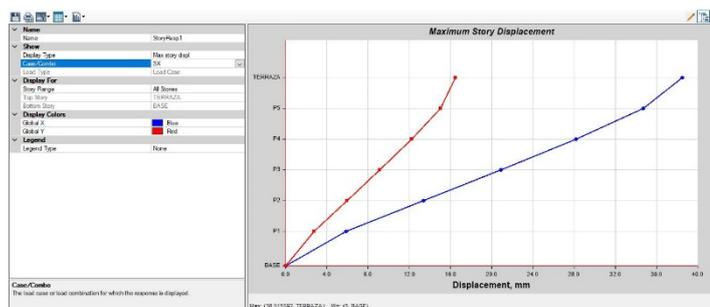
**Ilustración 3.7. Desplazamiento de pisos en la dirección X**
