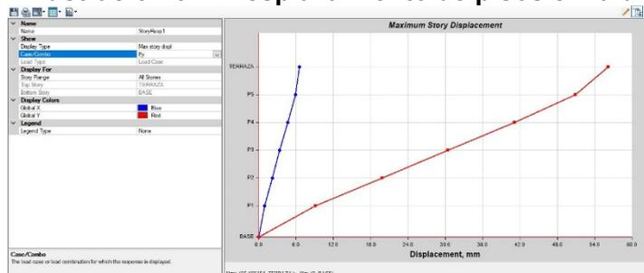
Ilustración 3.2. Desplazamiento de pisos en la dirección Y
