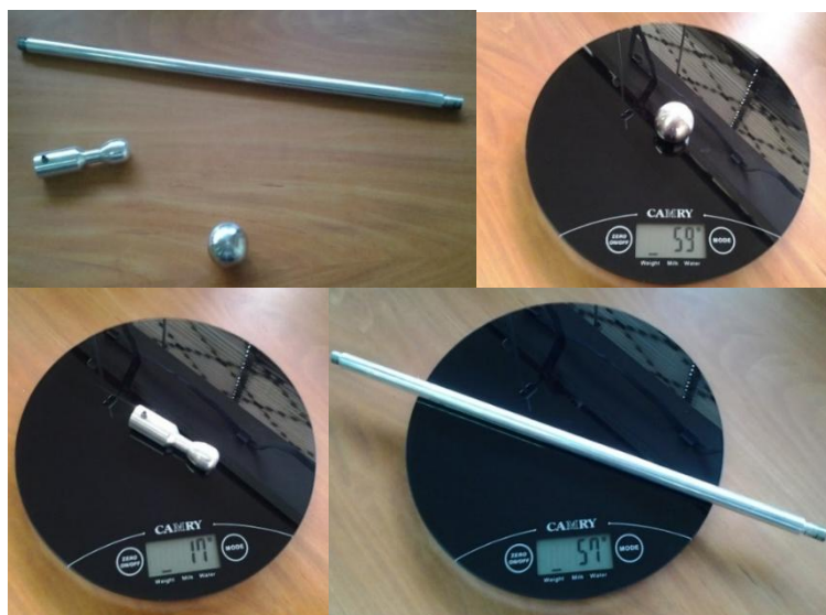
Figura 3.16 Medición de masa del péndulo
