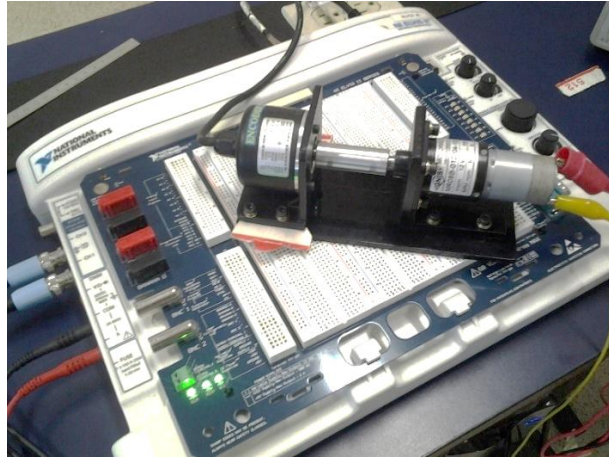
Figura 3.11 Medición de k_b utilizando módulo NI ELVIS II+
