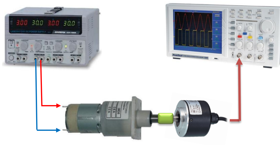
Figura 3.13 Medición de constante mecánica del motor.
