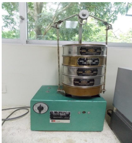
Figura 3.3. Tamizador portátil utilizado en la distribución del tamaño de partícula de sedimentos. Fuente: Santana L.
