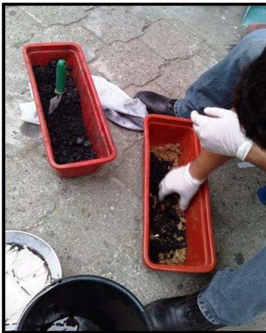
Figura 4.4 Mezclado de tierra contaminada con aserrín
