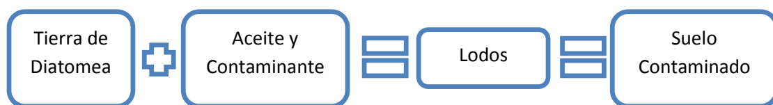
Figura 2.9. Matriz de Generación del desecho contaminante
