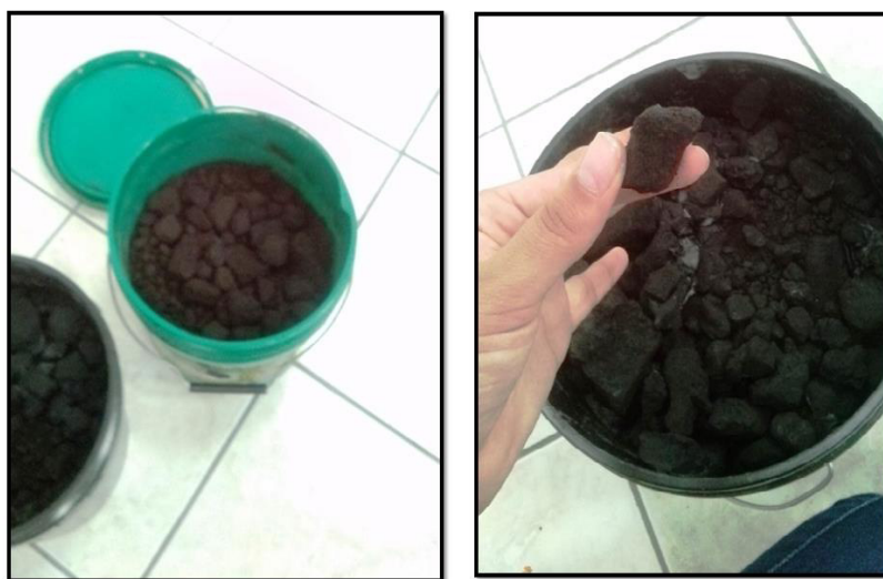
Figura 4.1 Tierras contaminadas con hidrocarburos
