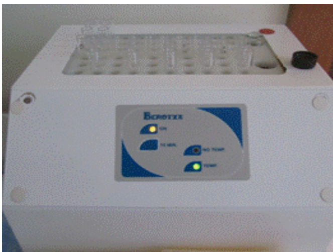
Figura3.3. Equipo utilizado para la incubación de las bacterias a 15 °C, Marca: Berotzx.
