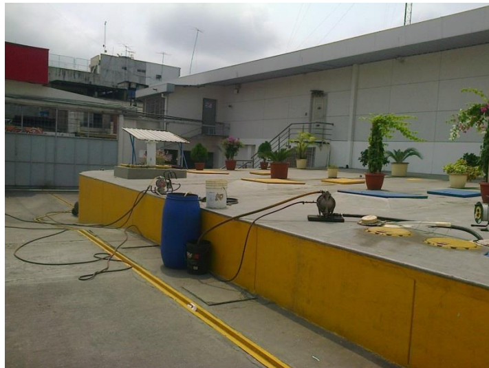
Figura 3.10. Muestreo del agua subterránea en un pozo de monitoreo de una E/S.
