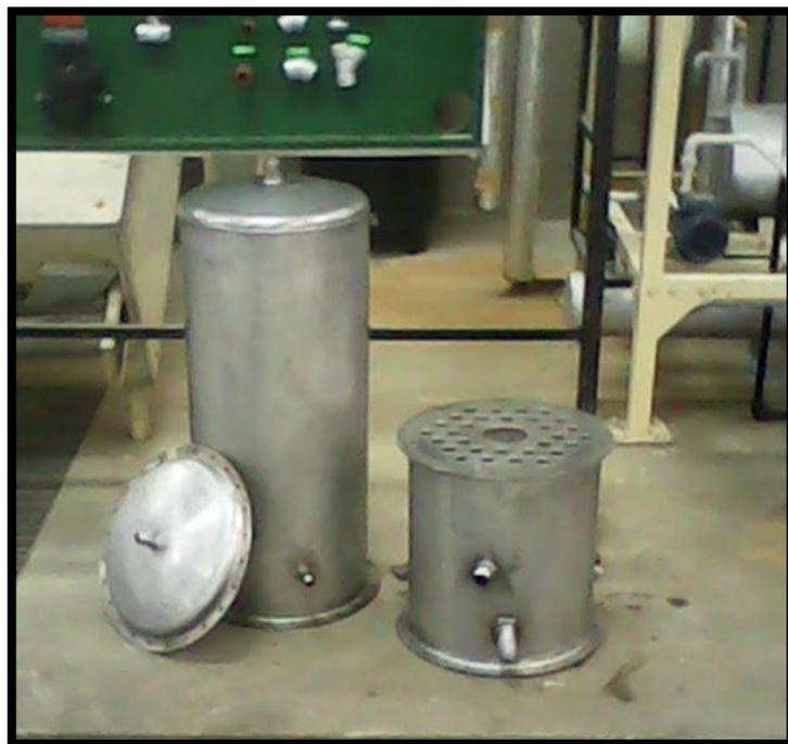
**Figura 5.1 Partes del Evaporador**
