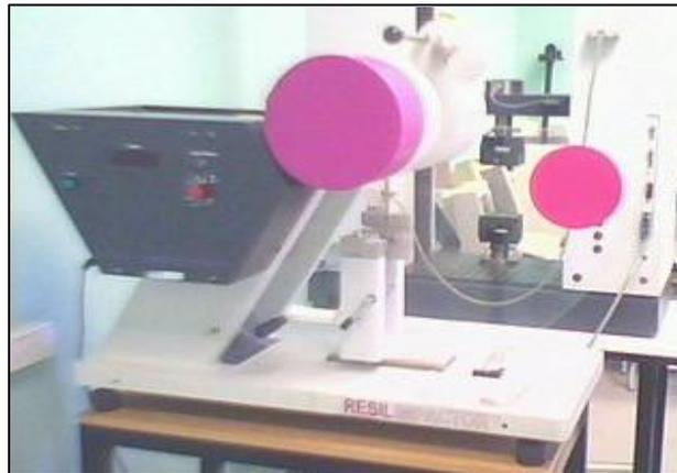
**Figura 5.5. Fotografía del Equipo de Ensayo de Charpy**
