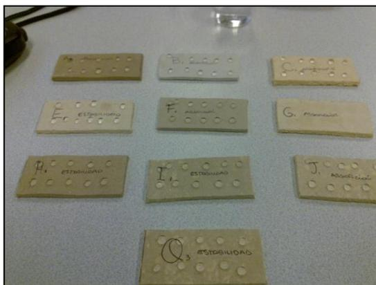
Figura 5.7. Fotografía del Ensayo de Permeabilidad
