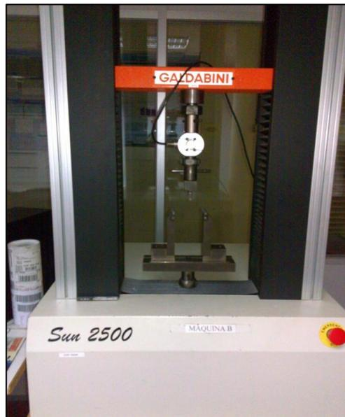
**Figura 5.4. Fotografía del Equipo de Ensayo de Flexión**
