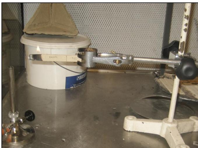
**Figura 5.6. Fotografía del Ensayo de Propagación de Llama.**
