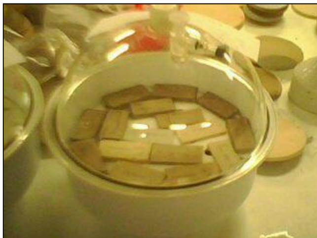
**Figura 5.8. Fotografía Ensayo de Higroexpansividad**
