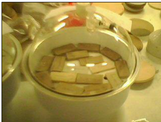
Figura 5.8. Fotografía Ensayo de Higroexpansividad
