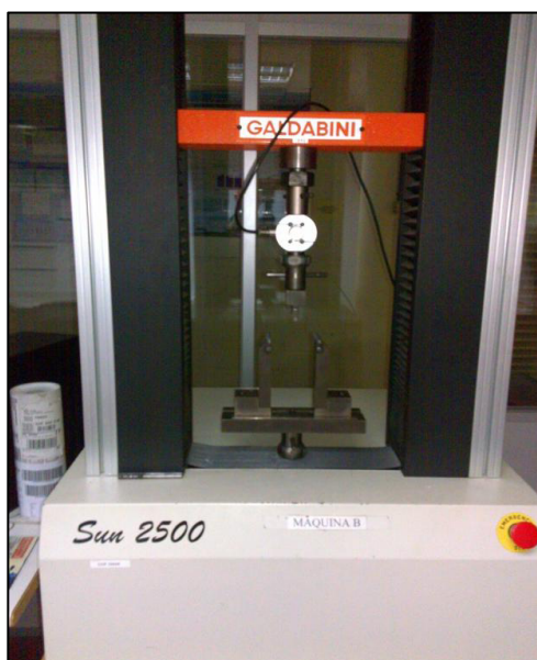
Figura 5.4. Fotografía del Equipo de Ensayo de Flexión
