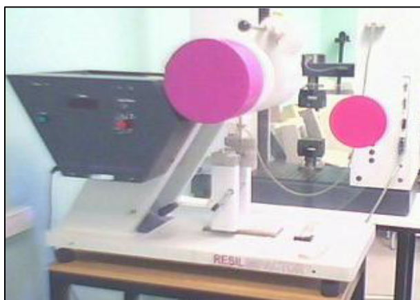
Figura 5.5. Fotografía del Equipo de Ensayo de Charpy
