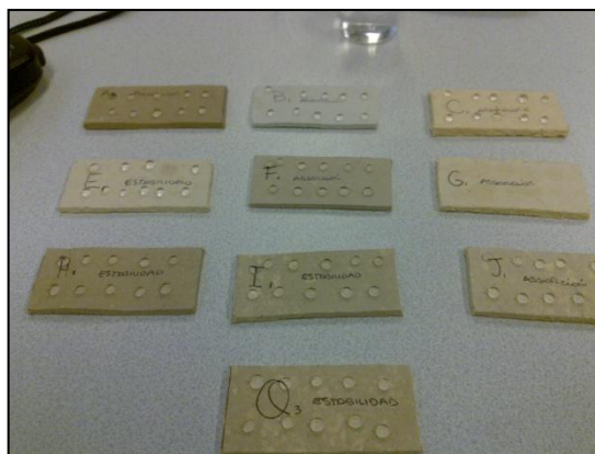
Figura 5.7. Fotografía del Ensayo de Permeabilidad
