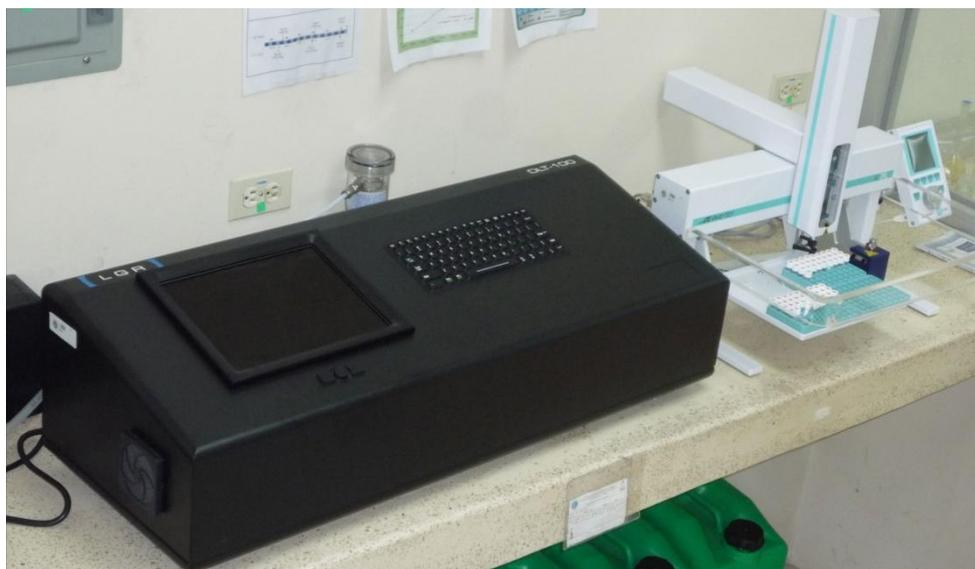
**Figura 4. 4 Equipo láser analizador de isótopos y automuestreador**
